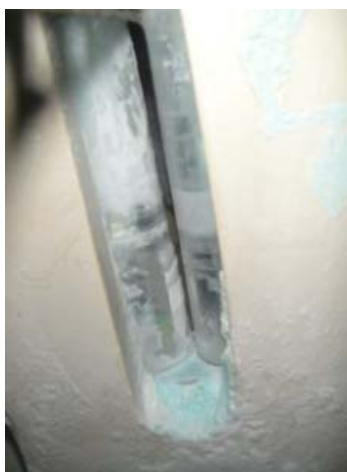
ภาพที่ 4.12 แสดงเกลือ Sodium ตกผลึกซึ่งสามารถชักวางชิ้นงานได้
