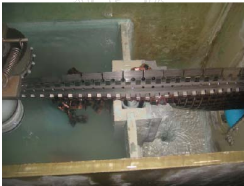
ภาพที่ 4.11 แสดงทางเข้าของ Cell ที่มีงานขั้ว ณ ทางเข้า Cell ซึ่งมีเกลือ Sodium ตกผลึก
