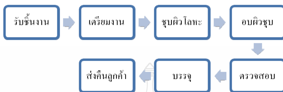
ภาพที่ 3.1 แสดงขั้นตอนการการผลิตของการชุบผิวโลหะด้วยไฟฟ้า
