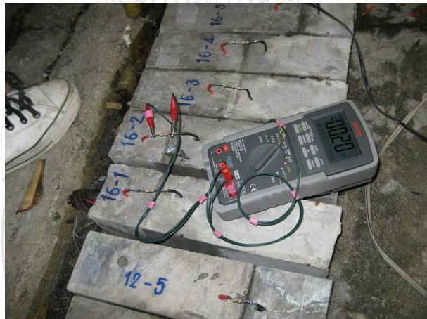
รูปที่ 3.12 การวัดความต่างศักย์ระหว่างแอโนดกับแคโทดด้วยโวลต์มิเตอร์
