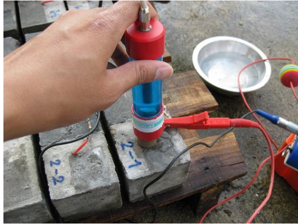
รูปที่ 3.11 การวัดโอกาสเกิดสนิมในเหล็กเสริมด้วยอุปกรณ์ Half-Cell Potential
