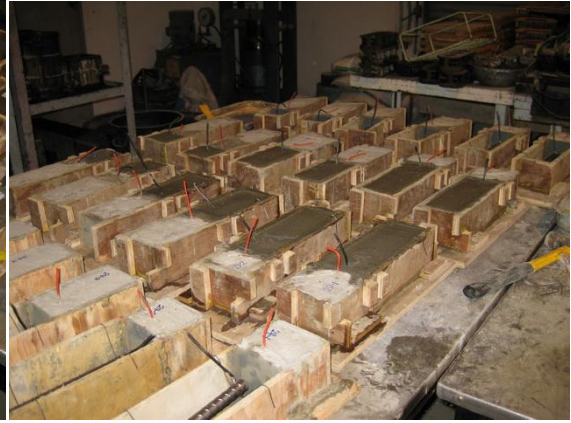
(ข) หล่อวัสดุซ่อมแซม
