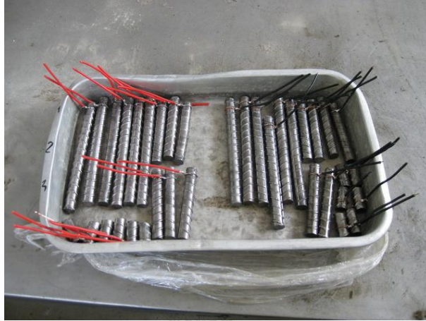
รูปที่ 3.6 เหล็กเสริมที่พร้อมใช้กับตัวอย่าง
