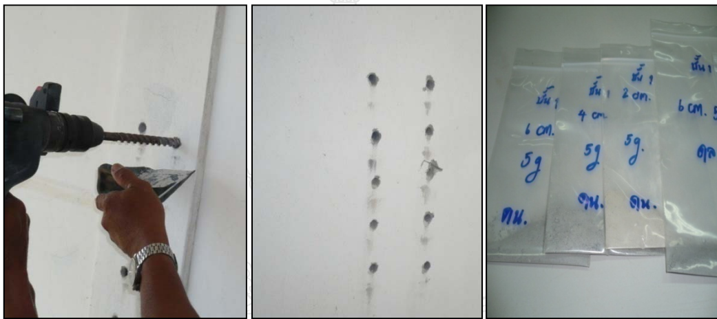
รูปที่ ก1 เจาะเก็บผงคอนกรีตทดสอบการแทรกซึมคลอไรด์
