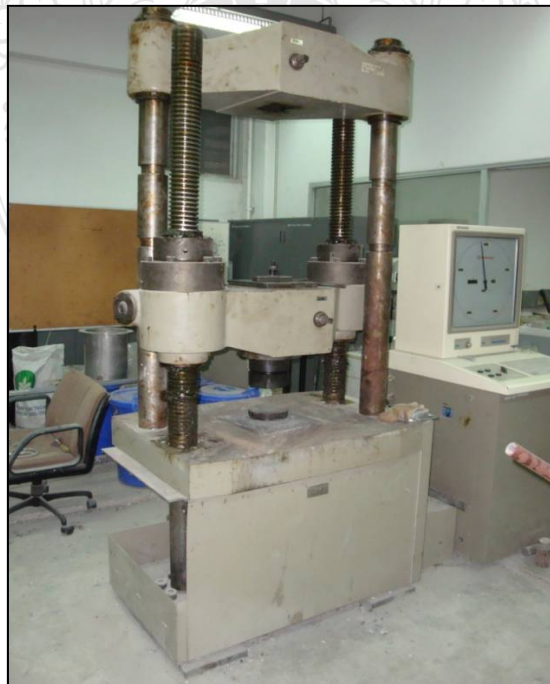
รูปที่ 3.6 เครื่องทดสอบ Universal Testing Machine (UTM)
