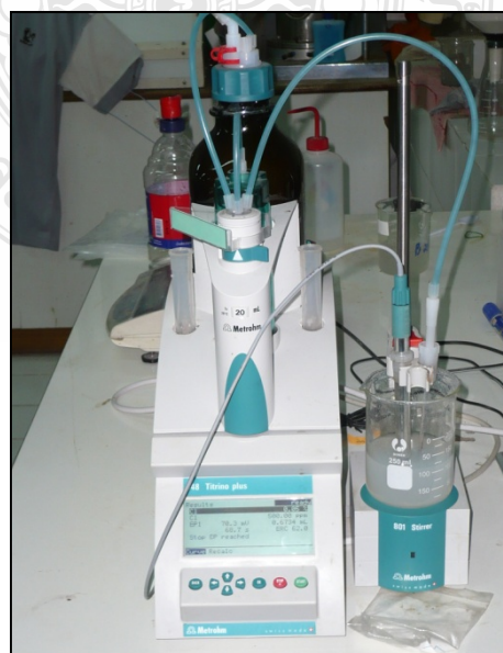
รูปที่ ก2 เครื่องมือวัดปริมาณคลอไรด์ด้วยการไตเตรชัน
