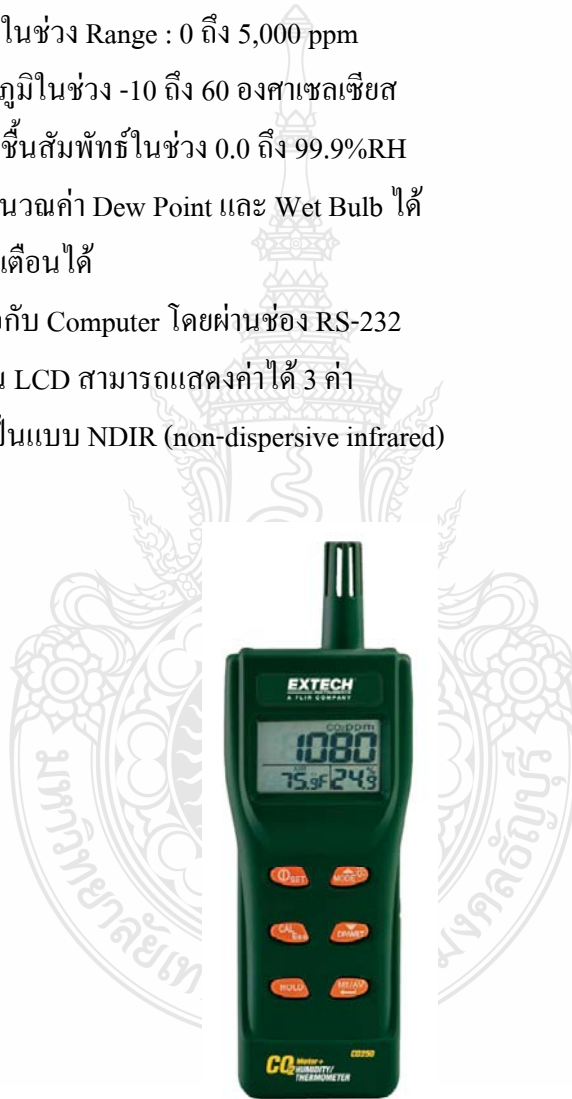
รูปที่ 2.7 เครื่องวัดก๊าซคาร์บอนไดออกไซด์, ความชื้นสัมพัทธ์และอุณหภูมียี่ห้อ Extech รุ่น CO250
