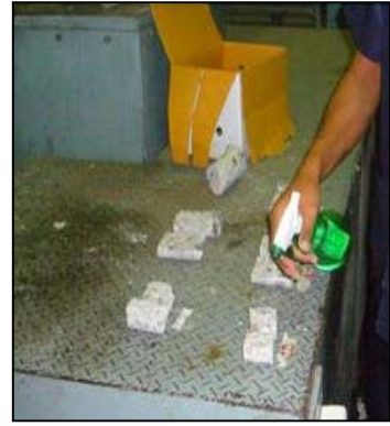
(ข) นำก้อนตัวอย่างที่ผ่าซีกกัดด้วยสารละลายฟีนอล์ฟธาไลน์
