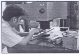
(ก) การนำซีกก้อนตัวอย่างคอนกรีต
