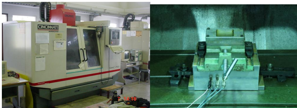
รูปที่ 2 ลักษณะการติดตั้งระบบจับยึดแผ่นโลหะในการขึ้นรูปด้วย กระบวนการ SPIF
