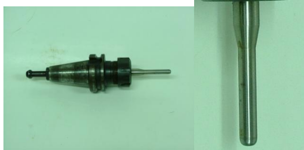
รูปที่ 3 ลักษณะของอุปกรณ์ที่ใช้ในการขึ้นรูปด้วย กระบวนการขึ้นรูปแบบต่อเนื่อง ด้วยการสัมผัสเป็นจุด
