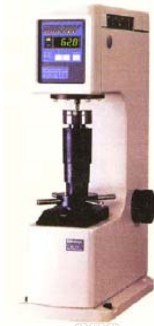
รูปที่ ข.10 เครื่องทดสอบ Hardness Rockwell R
