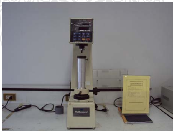
รูปที่ 3.9 เครื่องทดสอบความแข็ง แบบร็อกเวลล์ (Rockwell Hardness Test) รุ่น DXT-1
