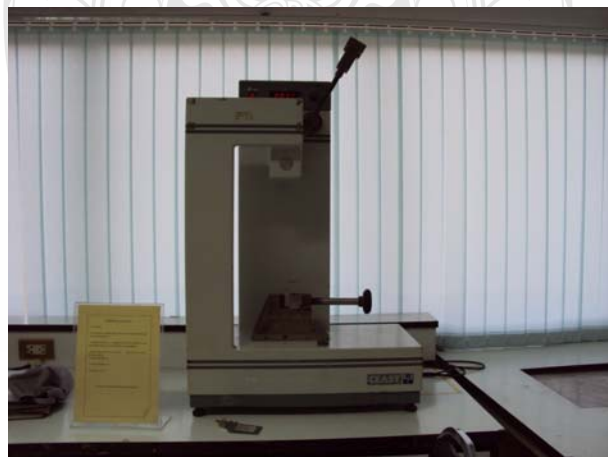
รูปที่ 3.7 เครื่องทดสอบการทนต่อแรงกระแทก
