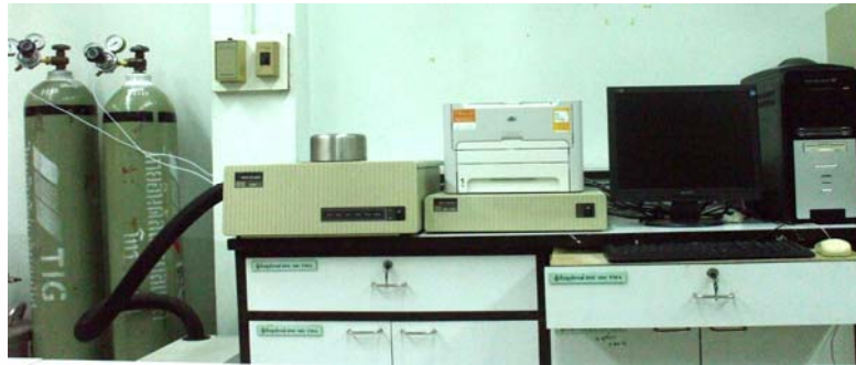
รูปที่ 3.10 เครื่องตรวจวัดความแตกต่างของพลังงาน Perkins-Elmer DSC TAC
