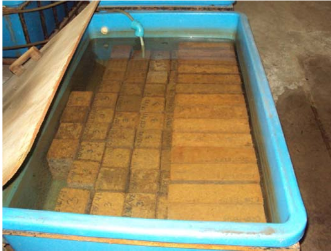
รูปที่ 3.6 ถังใส่สารละลายซัลเฟตและชิ้นตัวอย่างคอนกรีตที่ใช้ทดสอบการขยายตัวและการสูญเสีย น้ำหนักของตัวอย่างคอนกรีตในสารละลายซัลเฟต
