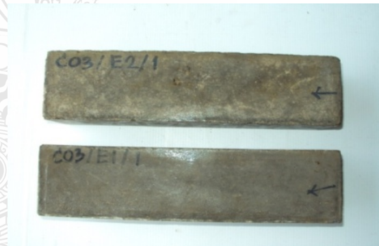
(ข) ชิ้นตัวอย่างคอนกรีตขนาด 7.5x7.5x28.5 ซม. 3
