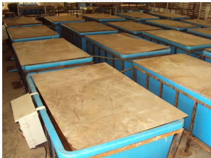
รูปที่ 3.7 ถังพร้อมระบบหมุนเวียนสารละลายซัลเฟตในการแช่ตัวอย่างคอนกรีต
