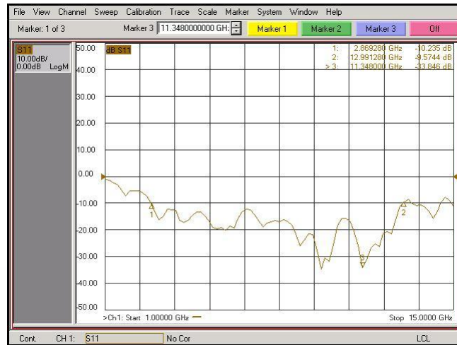
รูปที่ 4.17 ผลการวัดค่าความสูญเสียย้อนกลับ ( S_{11} ) ของสายอากาศที่สร้างขึ้น
