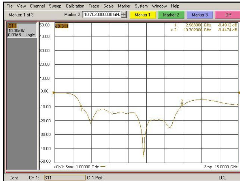
รูปที่ 4.4 ผลการวัดค่าความสูญเสียย้อนกลับของสายอากาศที่สร้างขึ้น
