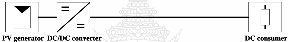
รูปที่ 2.4 ระบบผลิตไฟฟ้าจากเซลล์แสงอาทิตย์ผ่านคอนเวอร์เตอร์
