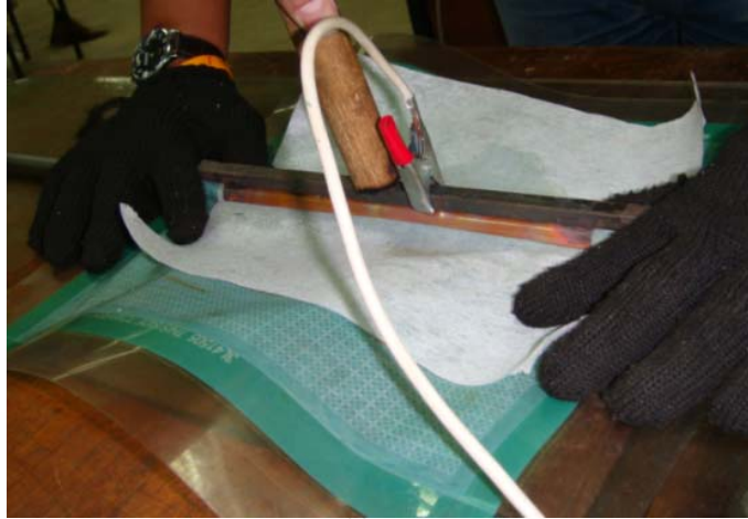
รูปที่ 3.30 การปล่อนกระแสไฟฟ้าเพื่อทำการกัดผิวโลหะ
