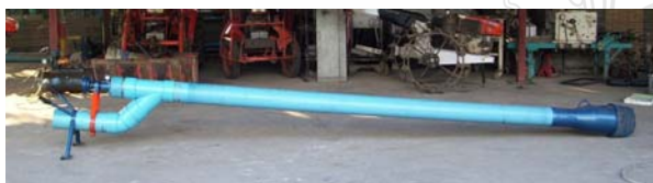
รูปที่ 2. ตัวอย่าง Prototype เครื่องสูบน้ำประเภทท่อสูบน้ำ การเกษตรแบบปรับความยาวได้
