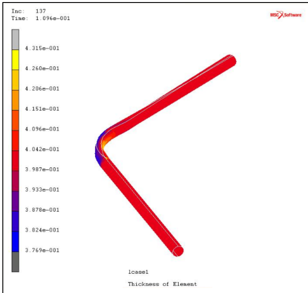
รูปที่ 3.20 ผลลัพธ์ของการวิเคราะห์ไฟไนต์เอลิเมนต์แบบ 3 มิติ
