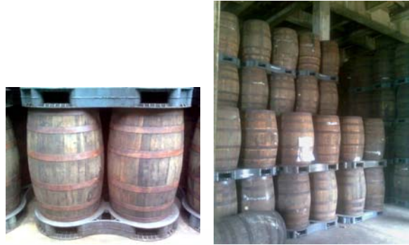
รูปที่ 7 การจัดเรียงถึงไม้โอ๊ค บนพาเลทพลาสติก
