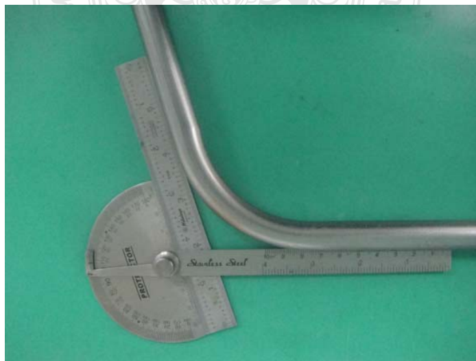
รูปที่ 3.44 การวัดองศาหลังการตัดโดยใช้ใบวัดมุม
