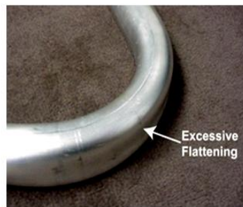
รูปที่ 2.53 หน้าตัดของท่อที่เกิดความบิดเบี้ยว [3]
