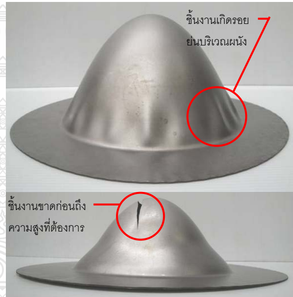
รูปที่ 5. ชิ้นงานทรงพาราโบลาที่มีโอกาสการเกิดรอยย่นบริเวณผนังและเกิดการฉีกขาดบริเวณด้านบน
