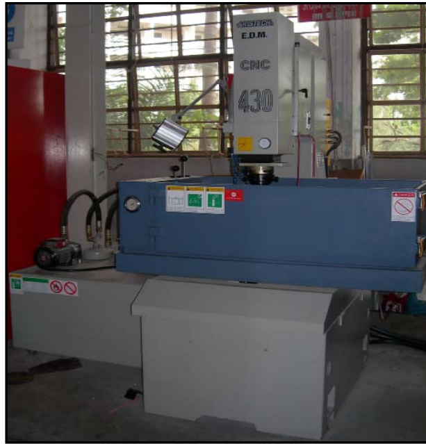
รูปที่ 3.7 เครื่องกัดเซาะโลหะด้วยกระแสไฟฟ้ายี่ห้อ Aristech รุ่น 3D-CNC EDM
