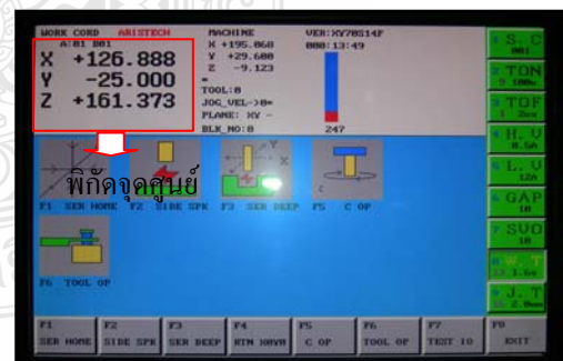
(ข) พิกัดแสดงค่าศูนย์ของอเล็กโตรดจากหน้าจอ
