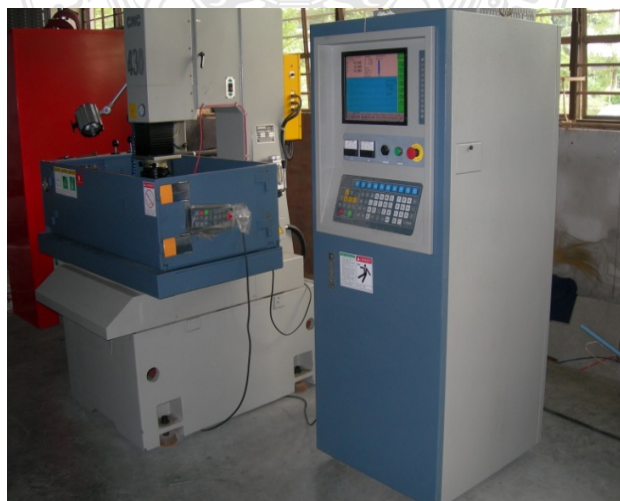
รูปที่ 3.5 เครื่องกัดโลหะด้วยไฟฟ้าที่ใช้ในการทดลอง รุ่น ARISTECH EDM CNC 430
