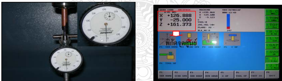
(ก) พิกัดแสดงค่าศูนย์ของอิเล็กโตรด (ข) ค่าที่อ่านได้จากหน้าปัดนาฬิกาเท่ากับ 0.01 มม.
