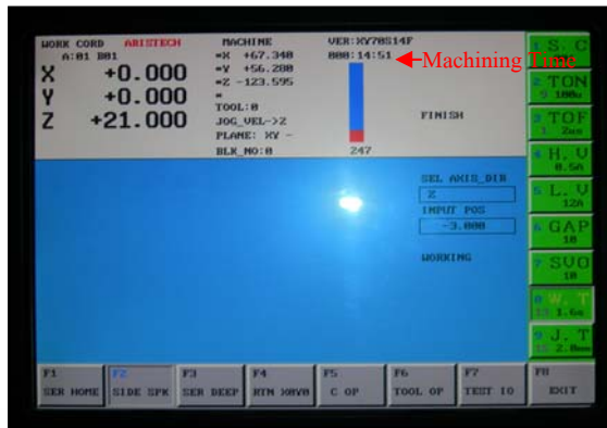
รูปที่ 3.8 หน้าจอแสดงเวลารวมในการทำงาน (Machining Time)
