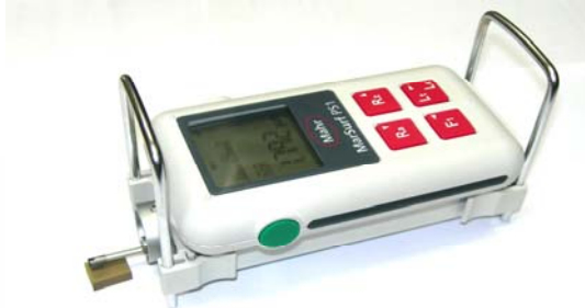
รูปที่ 3.6 เครื่องวัดความหนาผิวยี่ห้อ Mahr รุ่น SurfTest PS1
