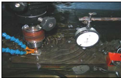
รูปที่ 3.12 การสปาร์คชิ้นงานทั้งสแตนคาร์ไบด์
