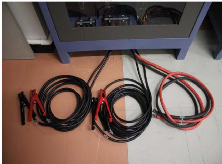
รูปที่ 3.2 ลักษณะสายต่อขั้วแบตเตอรี่ของเครื่องทดสอบแบตเตอรี่ [23]
