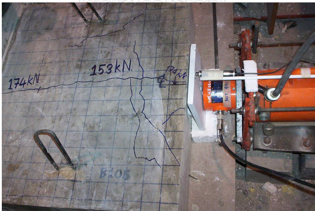
รูปที่ ข 25.2 การแตกร้าวของตัวอย่าง B105
