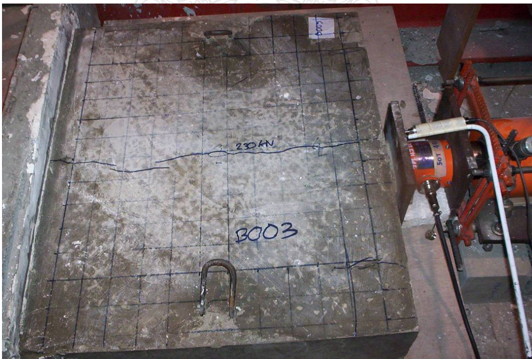
รูปที่ ข 35.2 การแตกร้าวของตัวอย่าง B003
