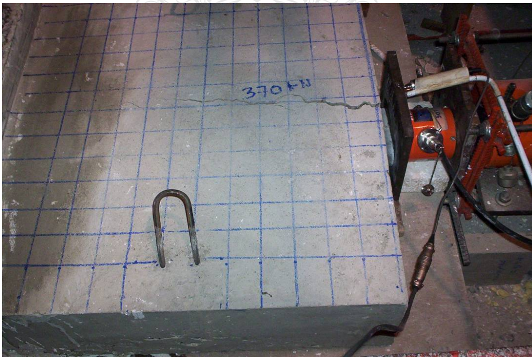
รูปที่ ข 33.2 การแตกร้าวของตัวอย่าง A004
