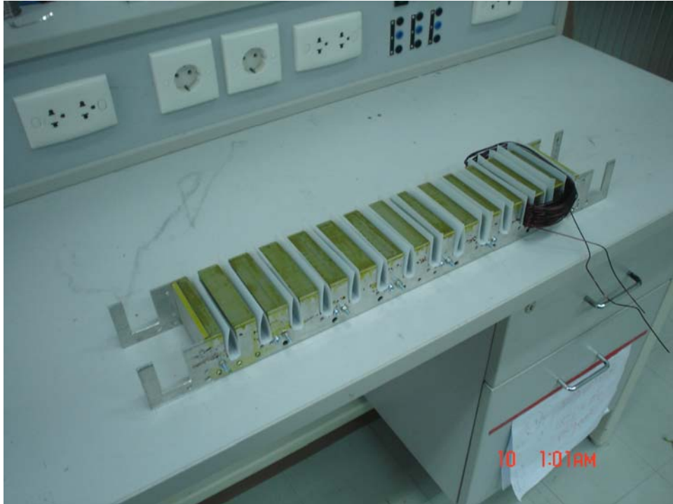
รูปที่ ก.3 เตรียมฉนวนเพื่อพันขดลวด
