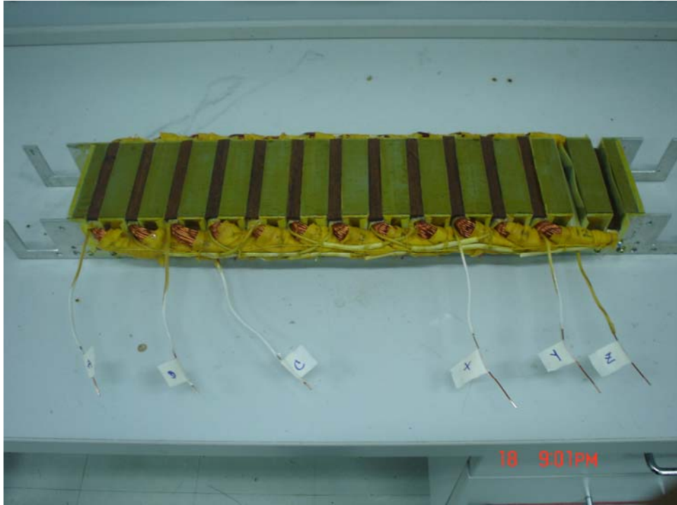
รูปที่ ก.5 เคลือบวานิช
