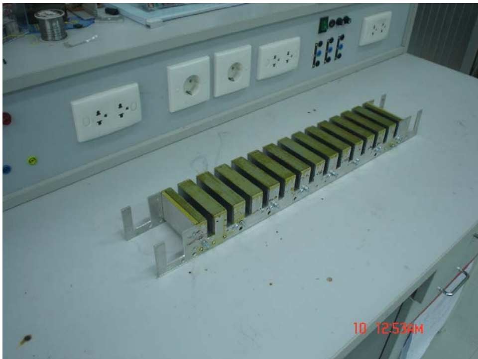
รูปที่ ก.2 เตรียมแกนด้วยการเคลือบวานิช
