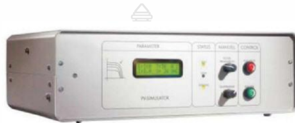
รูปที่ 3.20 อุปกรณ์ปรับค่าความเข้มแสงและอุณหภูมิของชุดแหล่งจ่ายพลังงานแสงอาทิตย์
