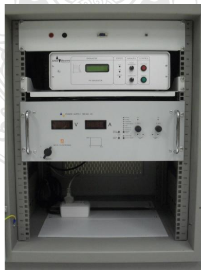
รูปที่ 3.19 ชุดจำลองแหล่งจ่ายพลังงานแสงอาทิตย์ (PV-Simulator)
