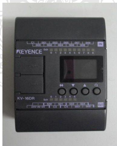
รูปที่ 3.25 ชุดควบคุม PLC
