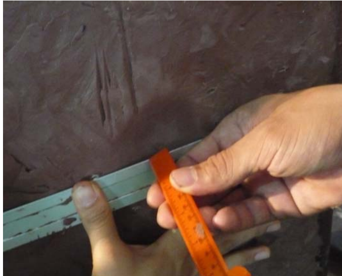
รูปที่ 3.31 วัดขนาดรอยขุดตัวของวัสดุหินหลังยิงทดสอบครบ 6 นัด
