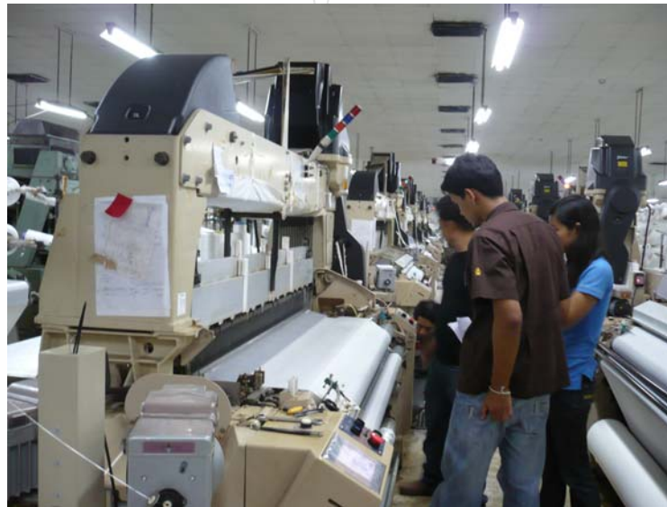
รูปที่ 3.15 นำเส้นด้ายไนลอน 6 ขนาด 840 ดีเนียร์ 192 ฟิลาเมนต์ มาทอเป็นผืนผ้าทอลายต่างๆ ด้วยเครื่องทอ Water jet ยี่ห้อ TSUDAKOMA รุ่น ZW 408 ของ บริษัท ไทยเททไฟต้า จำกัด
