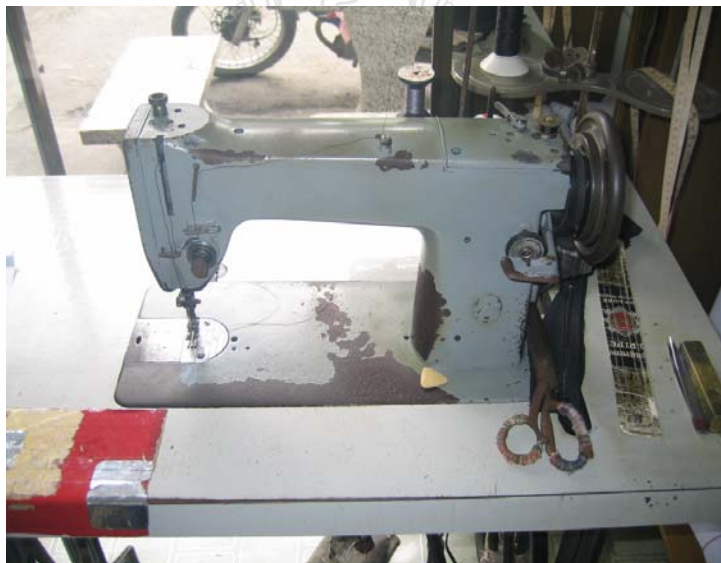
รูปที่ 3.12 จักรเย็บผ้าอุตสาหกรรมสำหรับเย็บชิ้นงานแบบเย็บผืนผ้าติดกัน ครั้งละ 10 ผืน
