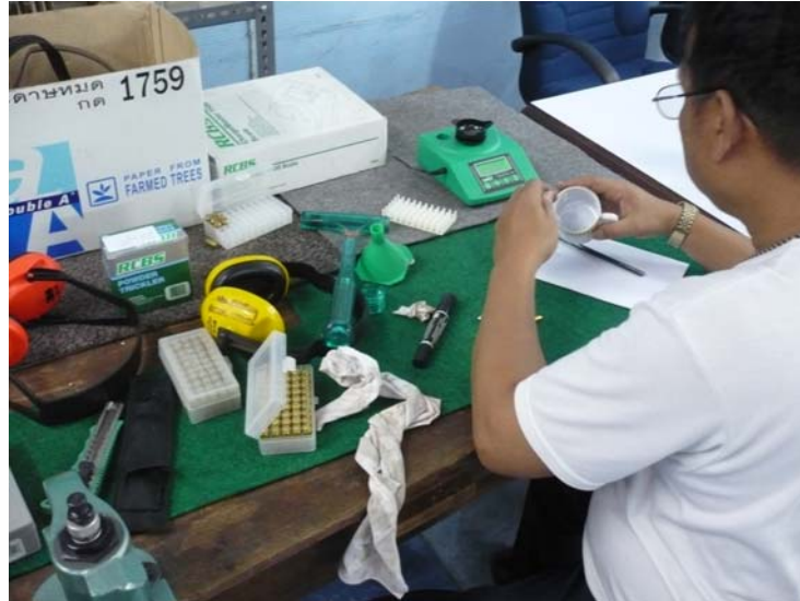
รูปที่ 3.25 เตรียมหัวกระสุนขนาด 9 มม. ประกอบกับปลอกกระสุนพร้อมดินปืน ให้ได้ความเร็วตามกำหนด
