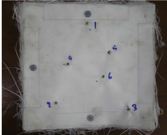
รูปที่ 3.29 แผ่นกระดาษแบบเย็บ กำลังทดสอบยิงด้วยกระสุนปืน 9 มม. ครบ 6 นัดแล้ว
