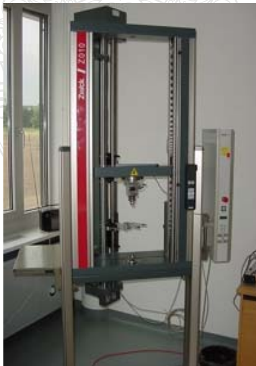
รูปที่ 3.8 เครื่องทดสอบแรงดึงยี่ห้อ Zwick รุ่น Z010 ของ บริษัท ไทย เทฟไฟต้า จำกัด
