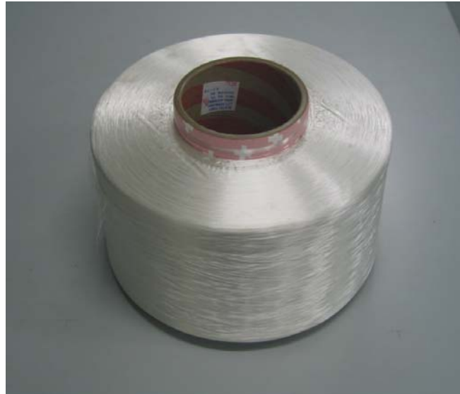
รูปที่ 3.3 เส้นด้ายไนลอน 6 ขนาด 840 ดีเนียร์ 192 ฟิลาเมนต์
