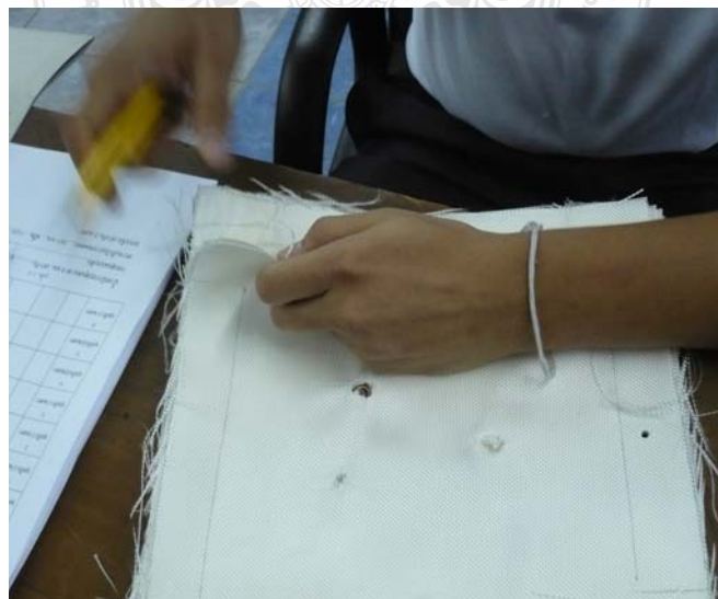
รูปที่.3.30 เลาะด้ายที่เย็บแผ่นกระดาษแบบเย็บก่อน จึงสามารถนับจำนวนชั้นทะลุได้
