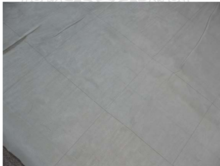
รูปที่ 3.18 ชิ้นผืนผ้าทอที่นำมาตัดเป็นชิ้นทดสอบ ขนาด 10x10 ตารางนิ้ว
