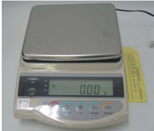
รูปที่ 3.9 เครื่องชั่งน้ำหนักไฟฟ้าขนาด 6000 กรัม ยี่ห้อ Vibra รุ่น AJ
