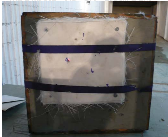
รูปที่ 3.28 กำหนดจุดยิงบนตัวอย่างแผ่นเกราะจุดที่ 1 มุมยิง 0 องศา
