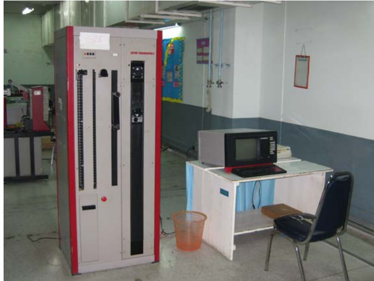
รูปที่ 3.7 เครื่องทดสอบค่าความแข็งแรงของเส้นด้าย (Tenacity) และค่าความยืดหยุ่นของเส้นด้าย (Elongation) ยี่ห้อ USTER TENSORAPID 3 ของ บริษัท ไทยเทฟไฟต้า จำกัด
