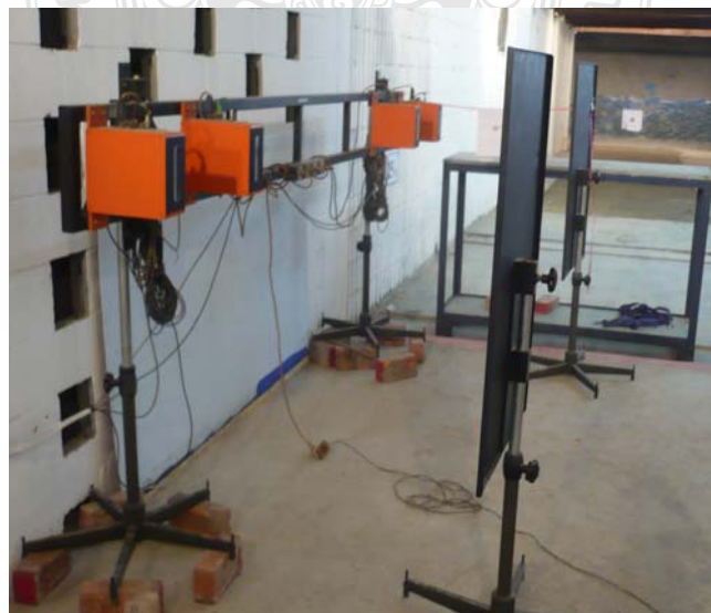
รูปที่ 3.23 ติดตั้งวางอุปกรณ์เครื่องจับความเร็ว ชุดที่ 1 กับชุดที่ 2 มีระยะห่างกัน 1.5 เมตร ± 6 เมตร
