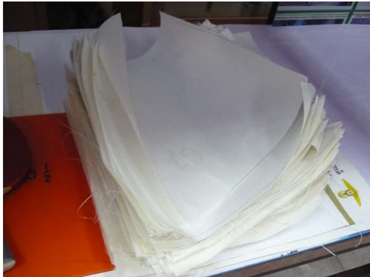
รูปที่ 3.19 ชิ้นทดสอบขนาด 10x10 ตารางนิ้ว มาวางเรียงซ้อนกัน โดยที่ให้แนวเส้นด้ายพุ่งและแนวเส้นด้ายยืนสลับกัน 90 องศา จำนวน 120 ชิ้นทดสอบ
