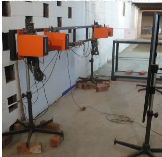
รูปที่ 3.10 เครื่องวัดความเร็วกระสุนปืนของกรมสรรพาวุธทหารอากาศ เป็นเครื่องวัดความเร็วกระสุนปืน ด้วยระบบแสง (Photo electric light screens) เป็น 1 ใน 4 แบบที่มาตรฐานกำหนด
