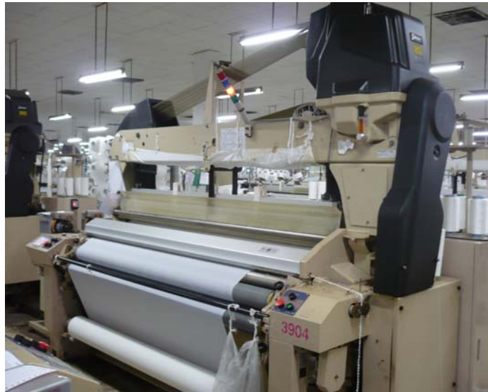
รูปที่ 3.5 เครื่องทอผ้า Water jet ยี่ห้อ TSUDAKOMA รุ่น ZW 408 ของ บริษัท ไทยเทฟไฟต้า จำกัด
