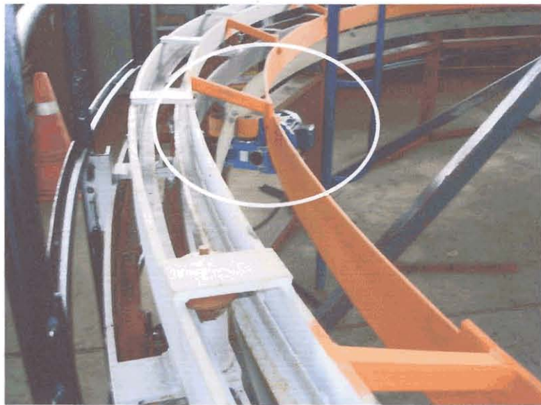
ภาพที่ 3.13 การติดตั้งตัวขับเคลื่อนกับรางล่างและรางบน
