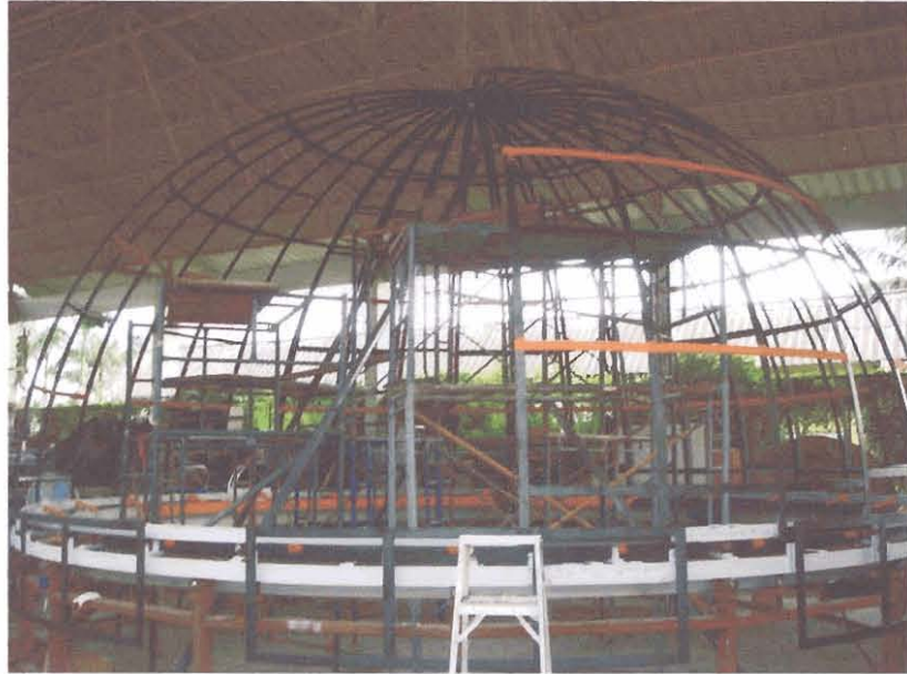
ภาพที่ 3.19 ทดสอบการหมุนของตัวโครงรูปโค้งกับชุดการขับเคลื่อน
