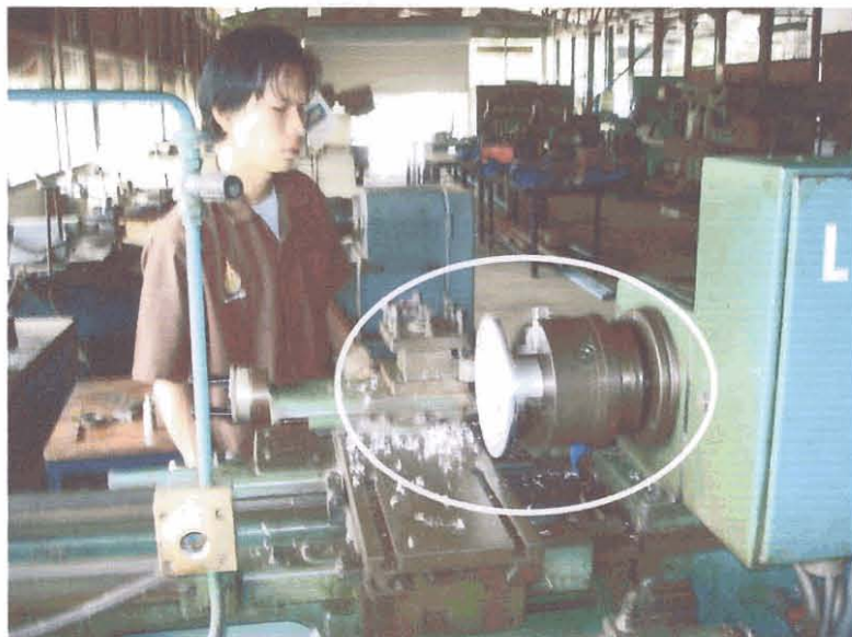
ภาพที่ 3.14 กลึงตัวยึดยึดตัวโครงรูปโค้ง
