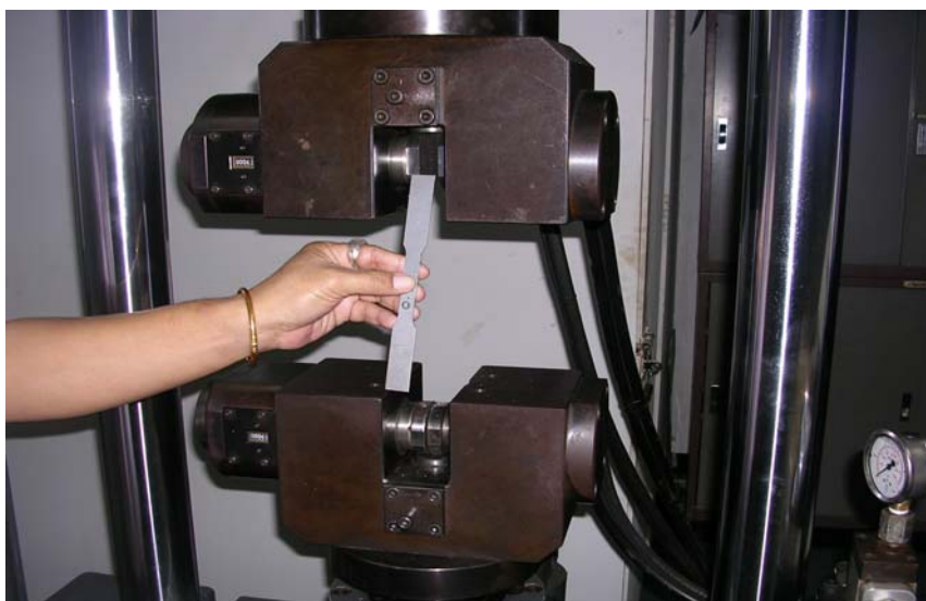
รูปที่ 3.4 การเตรียมประกอบทดสอบความแข็งแรงดึง
