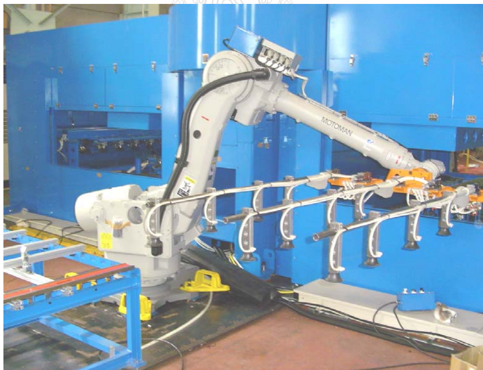
รูปที่ 2.6 นำชิ้นงานวางที่โต๊ะเชื่อม
