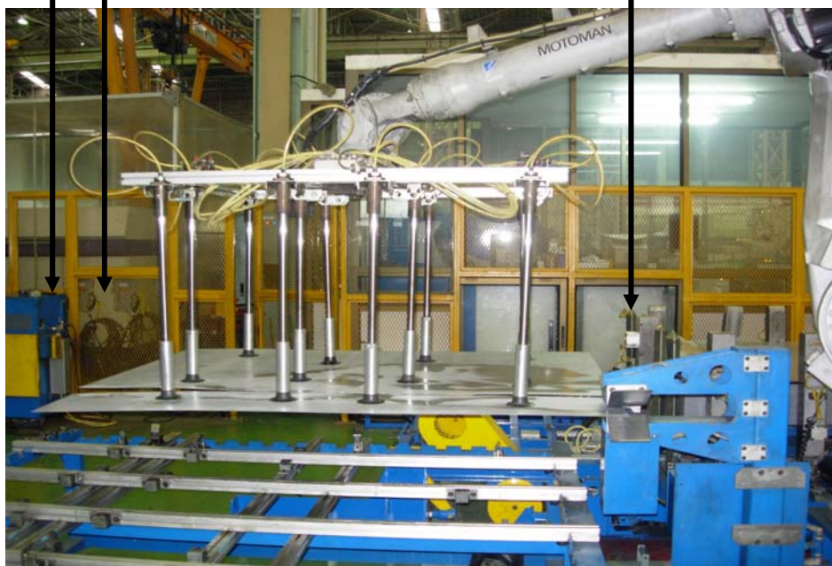
รูปที่ 3.9 ตรวจสอบความหนาที่โต๊ะตรวจสอบ
