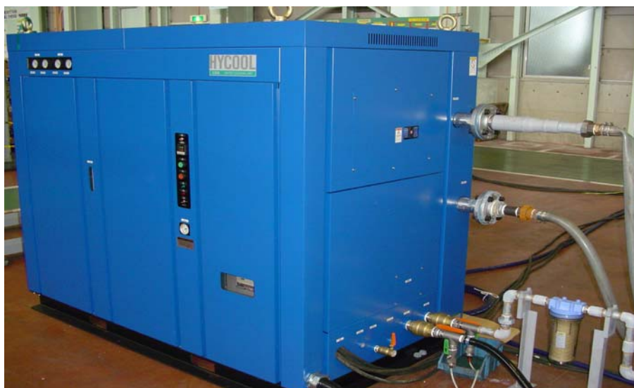
รูปที่ 2.3 เครื่องถ่ายเทความร้อน
