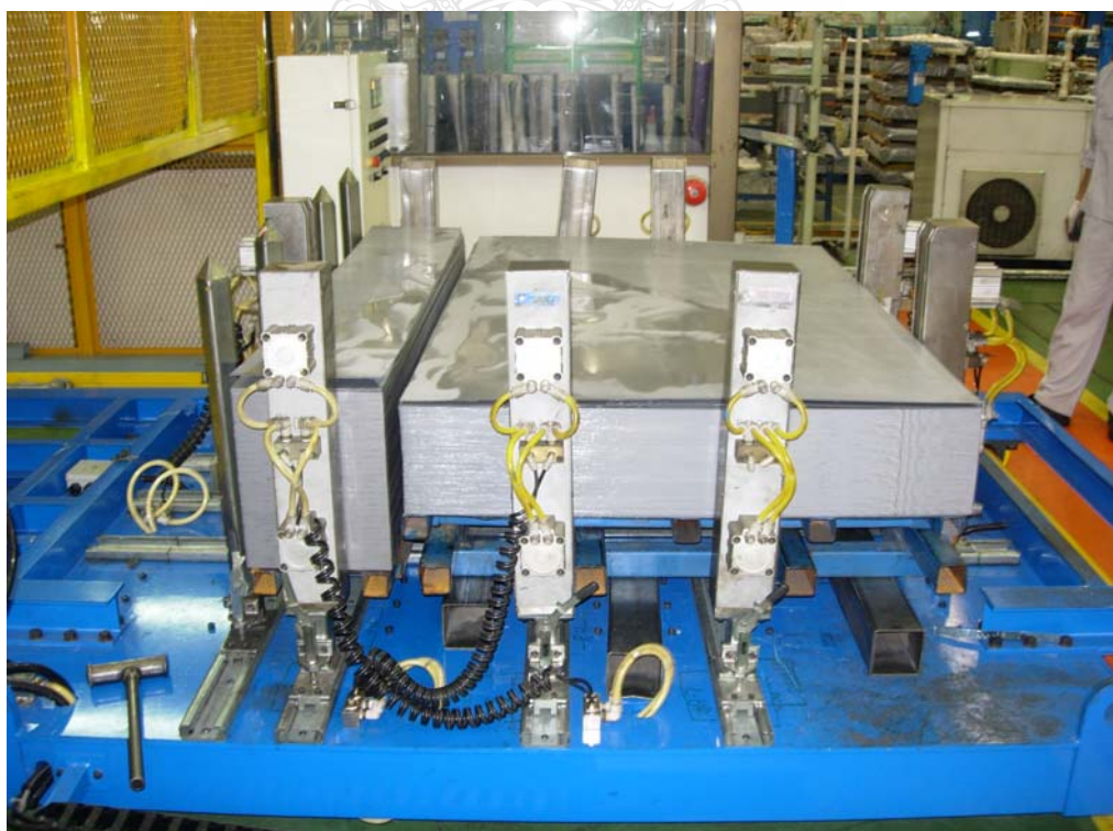
รูปที่ 2.12 โตะวางชิ้นงานก่อนตรวจสอบความหนา
