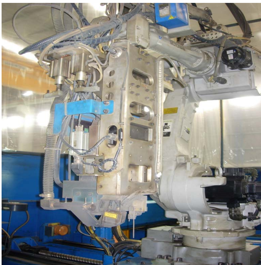
รูปที่ 2.1 Nd: YAG เลเซอร์ขนาด 3 กิโลวัตต์
