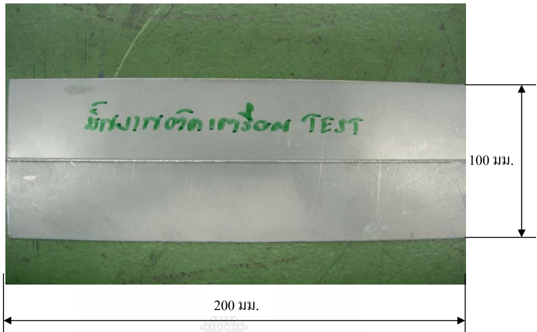
รูปที่ 3.24 ชิ้นงานที่ตัดเสร็จเตรียมไปทดสอบ
