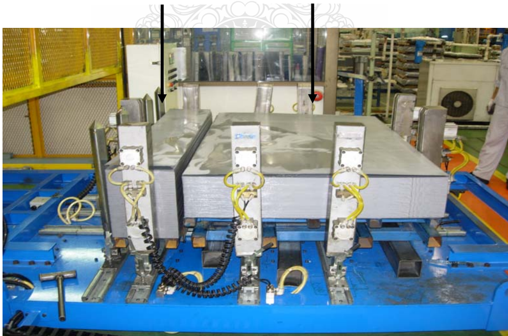
รูปที่ 3.6 โต๊ะสำหรับวางชิ้นงานก่อนวัดความหนา
