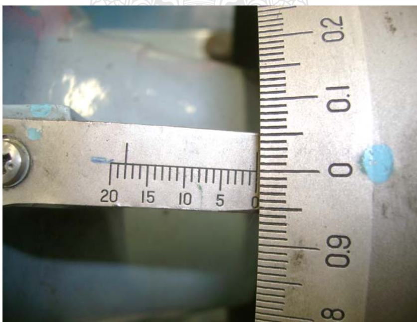
รูปที่ 3.27 สเกลวัดค่าการยึดเครื่องทดสอบการยึดตัว
