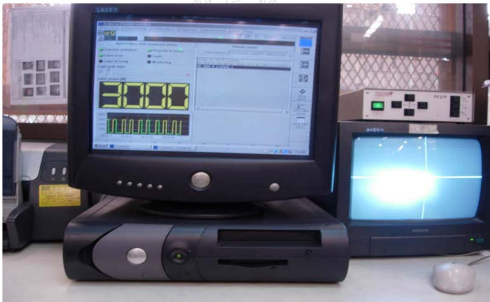
รูปที่ 3.17 ตรวจสอบพลังงานเลเซอร์
