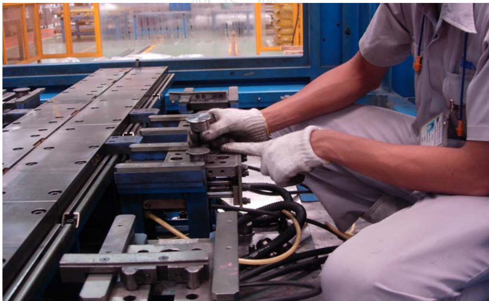
รูปที่ 3.15 ตรวจสอบตำแหน่ง Pusher
