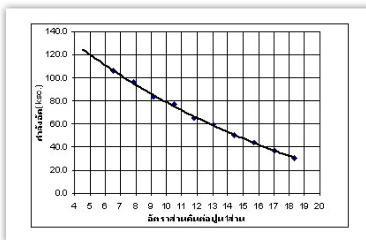
ภาพที่ 3.11 แสดงอัตราส่วนดินต่อปูน 1 ส่วนที่มีผลต่อกำลังอัด
