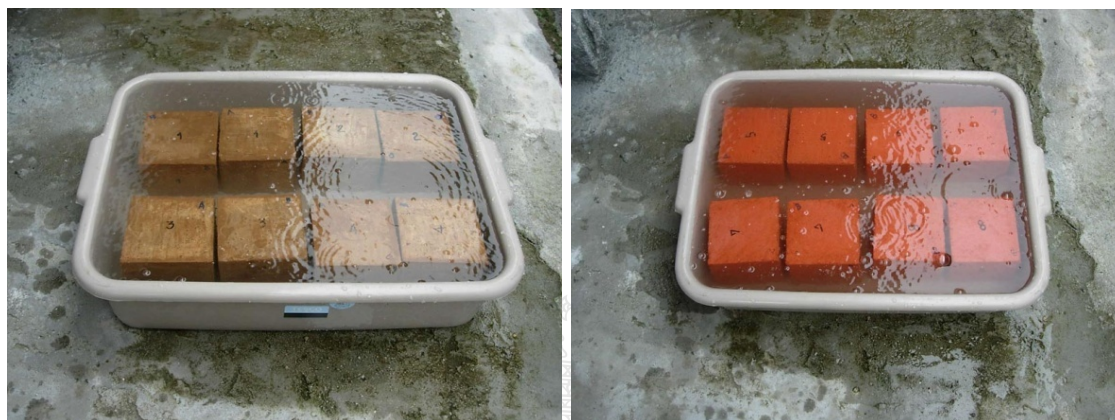
ภาพที่ 4.8 แสดงอุปกรณ์และเครื่องทดสอบการดูดซึมน้ำ
