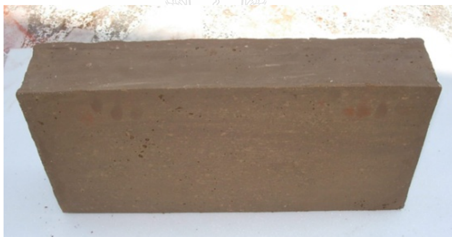
ภาพที่ 5.13 แสดงลักษณะของบล็อกต้นแบบ SP2 จากส่วนผสมของดินลูกรังผสมเชื้อกระจาย
