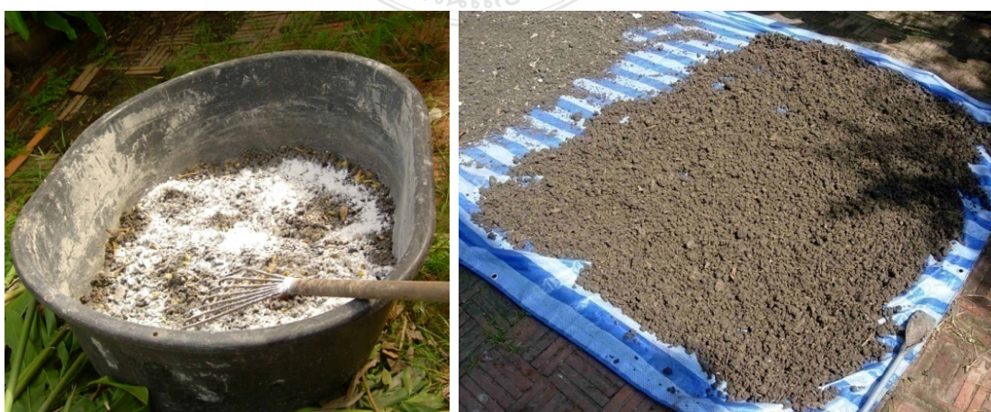
ภาพที่ 4.3 แสดงการตากกากตะกอนเยื่อกระดาษ
