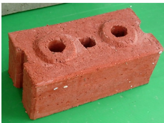
ภาพที่ 5.16 บล็อกประสานต้นแบบ SP6 ที่มีส่วนผสมของทรายและผงสีผสมเชื้อกระจาย
