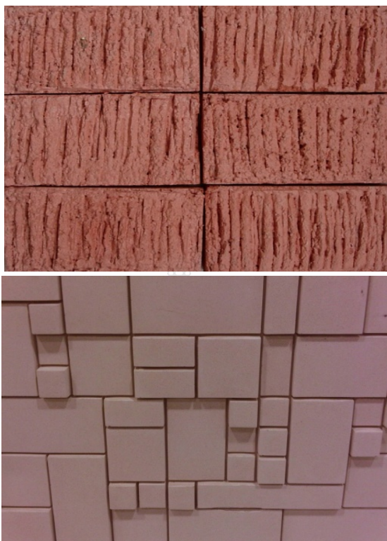
ภาพที่ 6.2 แสดงลักษณะวัสดุตกแต่งผนังมวลเบาชนิดใหม่
