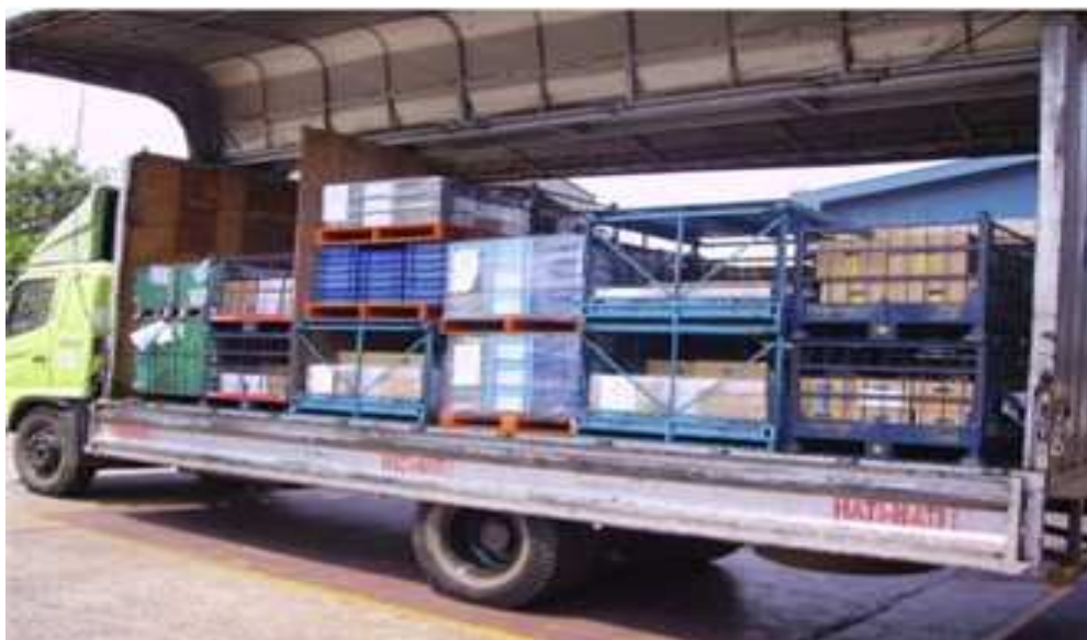
ภาพที่ 2.1 แสดงลักษณะการบรรทุกของมิลค์รัน (Milk Run) ที่ขีดความสามารถในการบรรทุกที่สูงขึ้นมีพื้นที่ว่างด้านบนน้อยมาก
