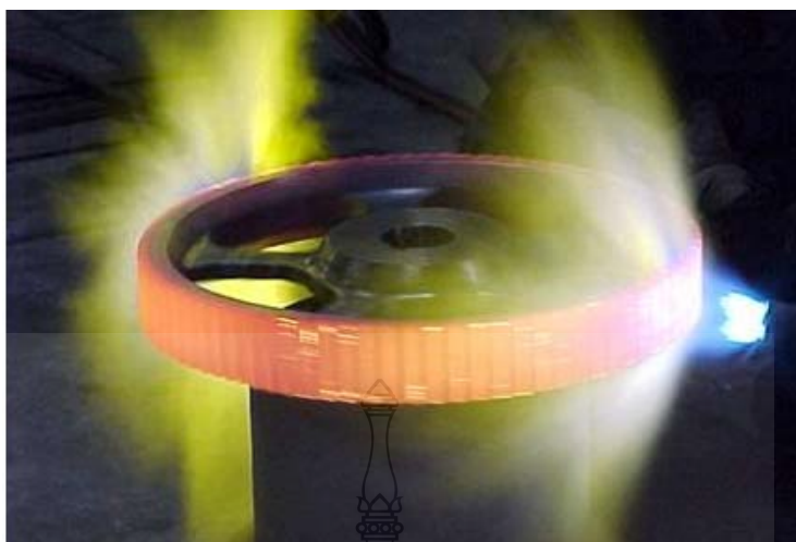
ภาพที่ 3.6 แสดงการอบชุบชิ้นงานเพื่อเพิ่มความแข็งแรง
