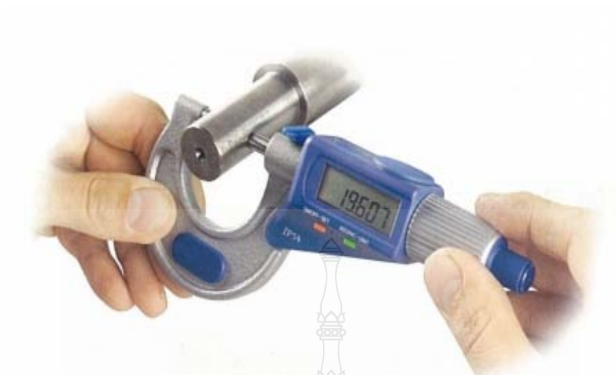
ภาพที่ 3.8 แสดงการวัดขนาดของชิ้นงาน
