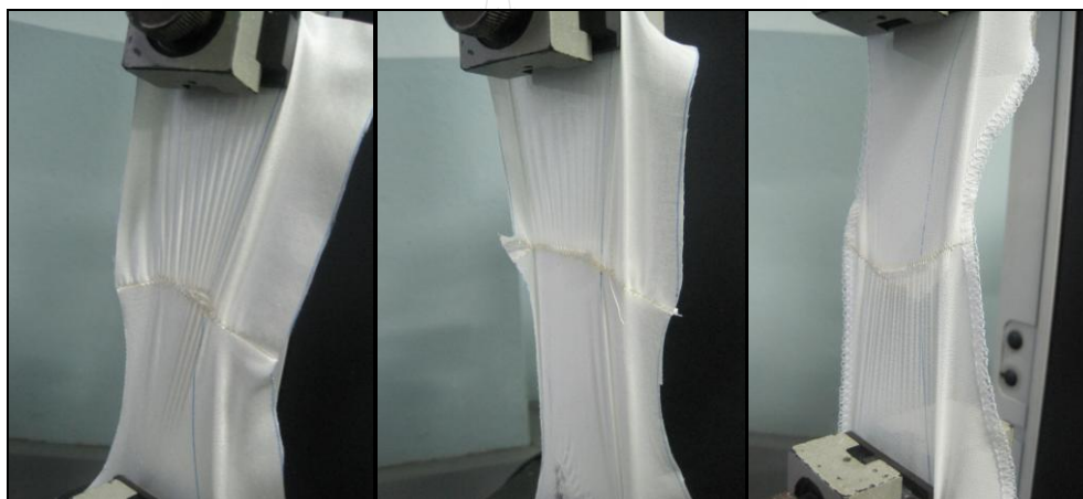
ภาพที่ 4.1 ตัวอย่างการทดสอบความแข็งแรงของตะเข็บ ผ้าไหม 1 เส้น ผ้าฝ้ายลินินและผ้าชีฟอง
