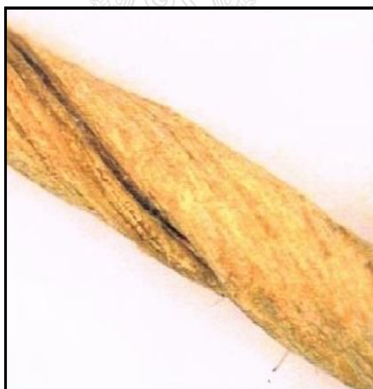
ภาพที่ 4.5 ภาพตามยาวของเส้นด้ายปอทะเลอายุ 3 เดือน กำลังขยาย 20X
