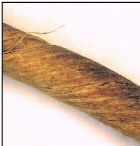
ภาพที่ 4.4 ภาพตามยาวของเส้นด้ายปอทะเลอายุ 2 เดือน กำลังขยาย 20X
