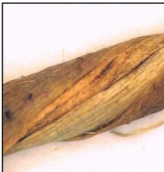
ภาพที่ 4.6 ภาพตามยาวของเส้นด้ายปอทะเลอายุ 4 เดือน กำลังขยาย 20X
