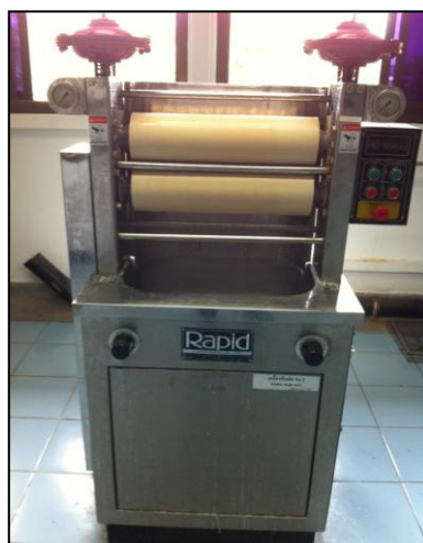
ภาพที่ 3.4 เครื่องบีบน้ำชนิดลูกกลิ้ง (Padding Mangle)
