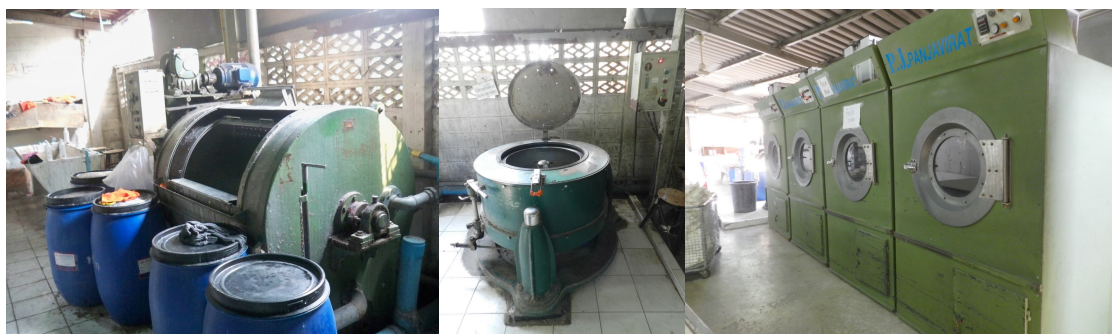
ภาพที่ 5 แผนกซักและอบ เครื่องซักผ้า(ซ้าย) เครื่องอบผ้า(กลาง) เครื่องอบผ้า(ขวา)
