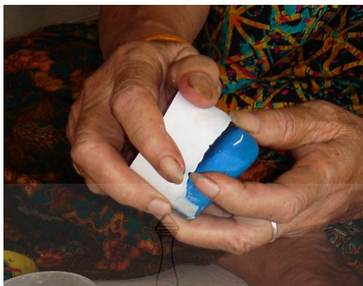
ภาพที่ 25 การแกะดินน้ำมันออกจากปูนพลาสติก้ออก
