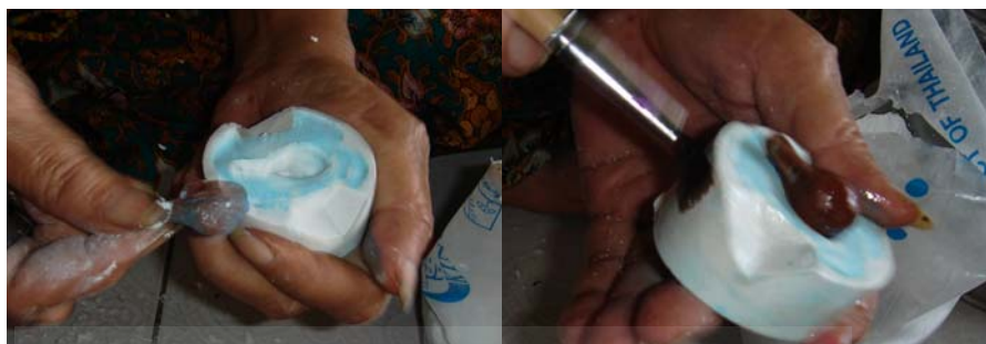
ภาพที่ 27 การตรวจความเรียบร้อยของพิมพ์ และทำน้ำมันให้ทั่วพิมพ์
