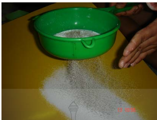
ภาพที่ 22 การกรองปูนปลาสเตอร์ผ่านตะแกรงร่อน
