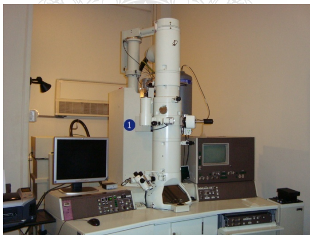
ภาพที่ 3.8 เครื่อง Transmission Electron Microscope (TEM) ณ ศูนย์เทคโนโลยีวัสดุและโลหะแห่งชาติ (MTEC)
