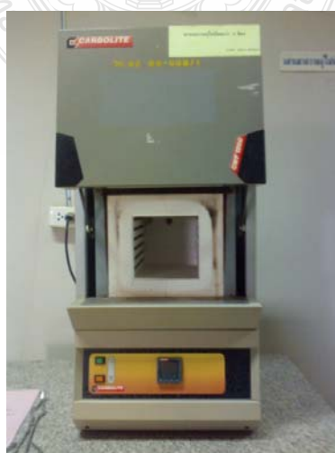
ภาพที่ 3.6 เตาเผาอุณหภูมิสูง ณ ภาควิชาวิศวกรรมเคมีและวัสดุ
