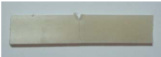
ภาพที่ 3.24 ชิ้นทดสอบการทนต่อแรงกระแทกตามมาตรฐาน ASTM D256
