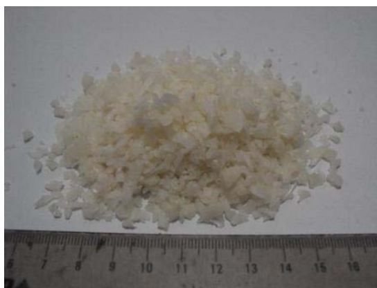
ภาพที่ 3.17 ลักษณะของโพลิโพรพิลีนที่ได้จากการบดด้วยเครื่องบดพลาสติก
