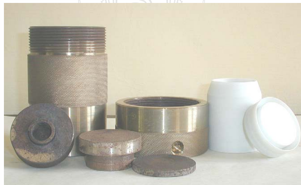
ภาพที่ 3.1 ลักษณะของถังปฏิกรณ์ (Autoclave) ซึ่งใช้ในการสังเคราะห์ในระดับห้องปฏิบัติการ [57]
