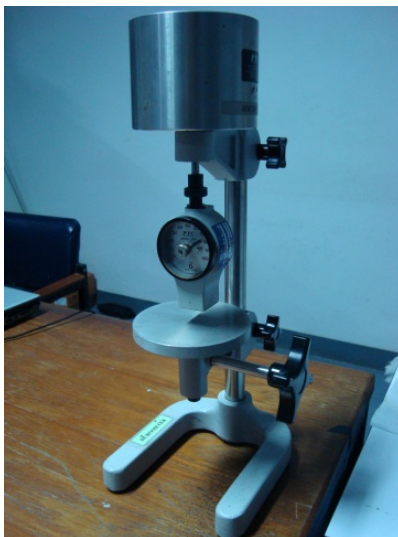
ภาพที่ 3.23 เครื่องทดสอบความแข็งแบบ Shore Durometer
