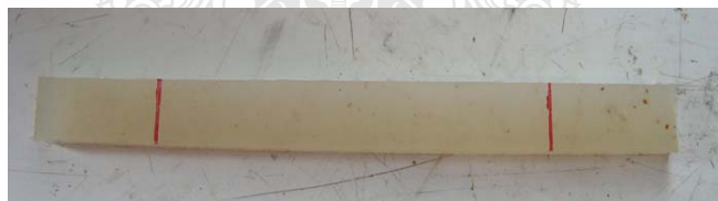
ภาพที่ 3.27 ชิ้นงานสำหรับทดสอบการลามไฟของวัสดุ
