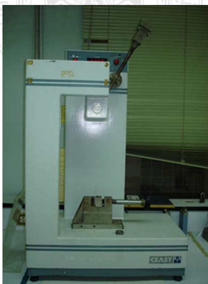
ภาพที่ 3.26 เครื่องทดสอบการทนต่อแรงกระแทก
