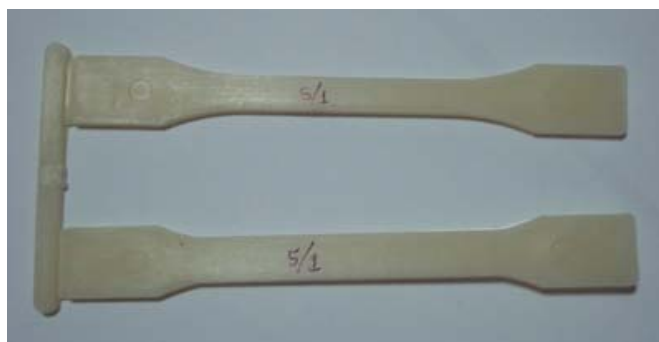
ภาพที่ 3.19 ลักษณะชิ้นงานที่ได้จากการฉีดขึ้นรูป
