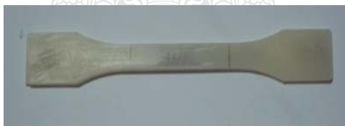
ภาพที่ 3.20 ชิ้นงานสำหรับทดสอบค่าความต้านทานแรงดึง
