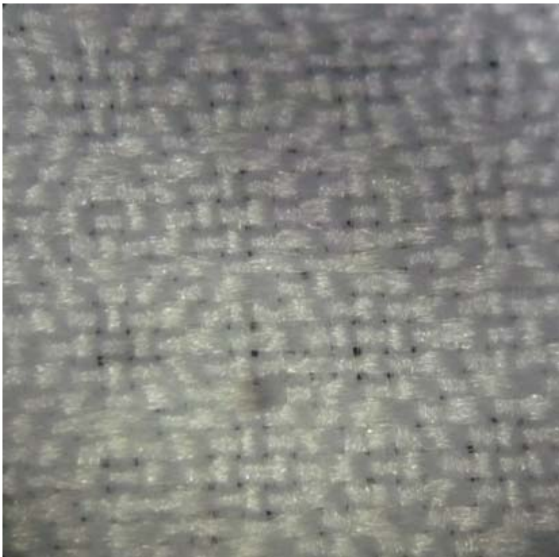
ภาพที่ ก.7 โครงสร้างผ้าทอแบบที่ 7 ลายทแยงตัดแปลง หน้ากระจัด
