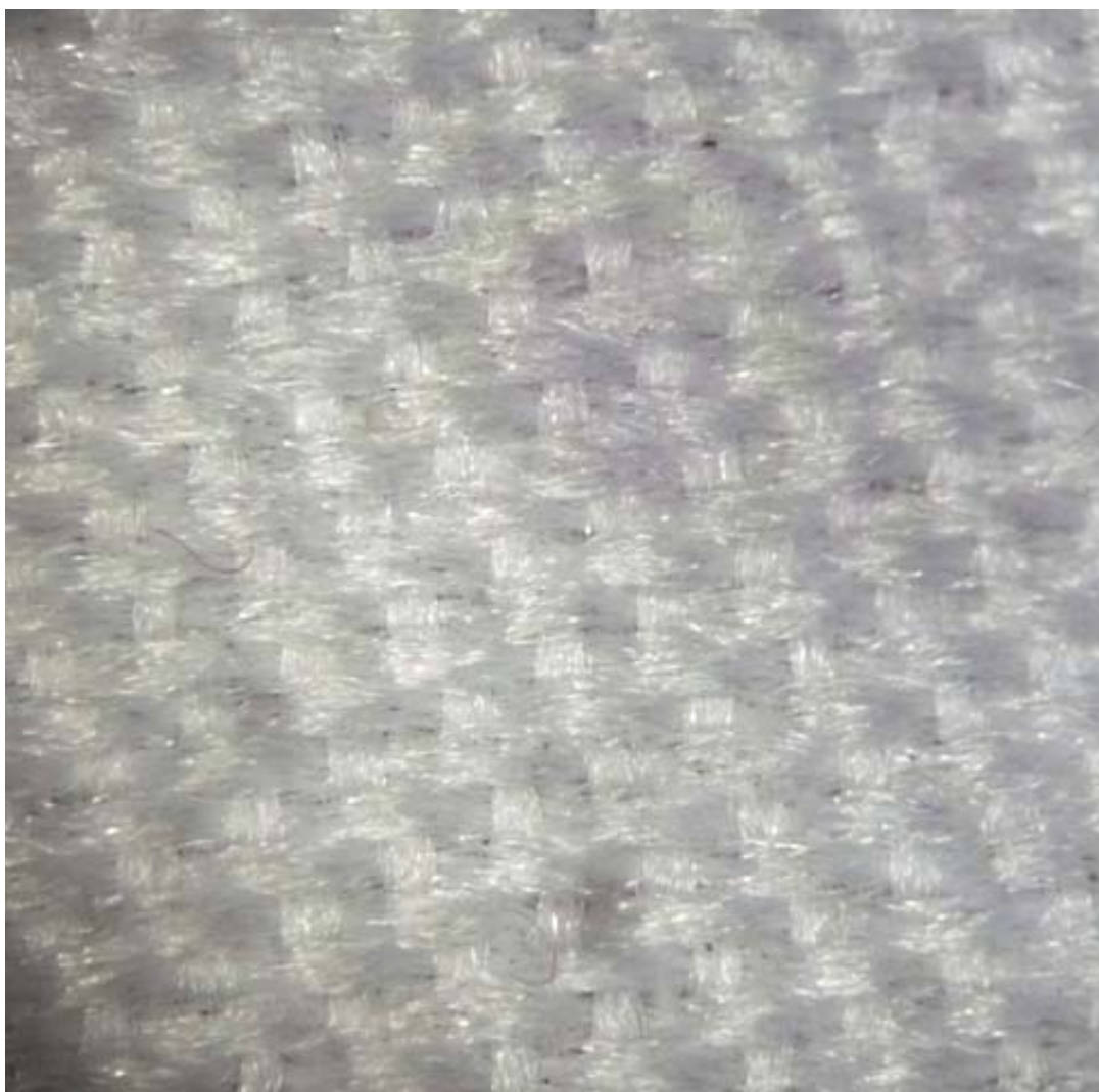
ภาพที่ ก.8 โครงสร้างผ้าทอแบบที่ 8 ลายต่วน 5 ตะกอ (ขึ้น 1 ลง 4)
