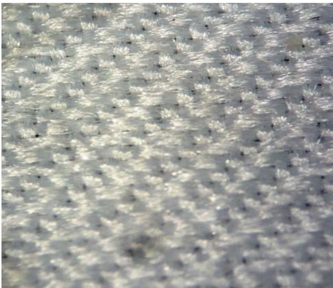
ภาพที่ ก.5 โครงสร้างผ้าทอแบบที่ 5 ลายทแยงตัดแปลง (s-twill 2/2)
