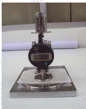
ภาพที่ 3.14 เครื่องมือทดสอบความหนาบางของผ้า
