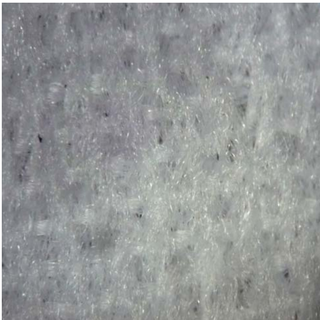
ภาพที่ ก.10 โครงสร้างผ้าทอแบบที่ 10 ลายต่วน 10 ตะกอ (ขึ้น 1 ลง 9)
