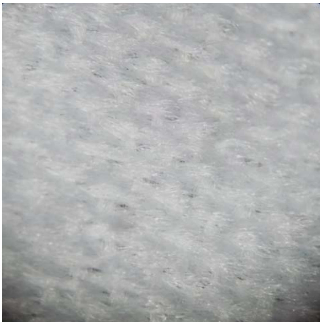
ภาพที่ ก.9 โครงสร้างผ้าทอแบบที่ 9 ลายต่วน 8 ตะกอ (ขึ้น 1 ลง 7)
