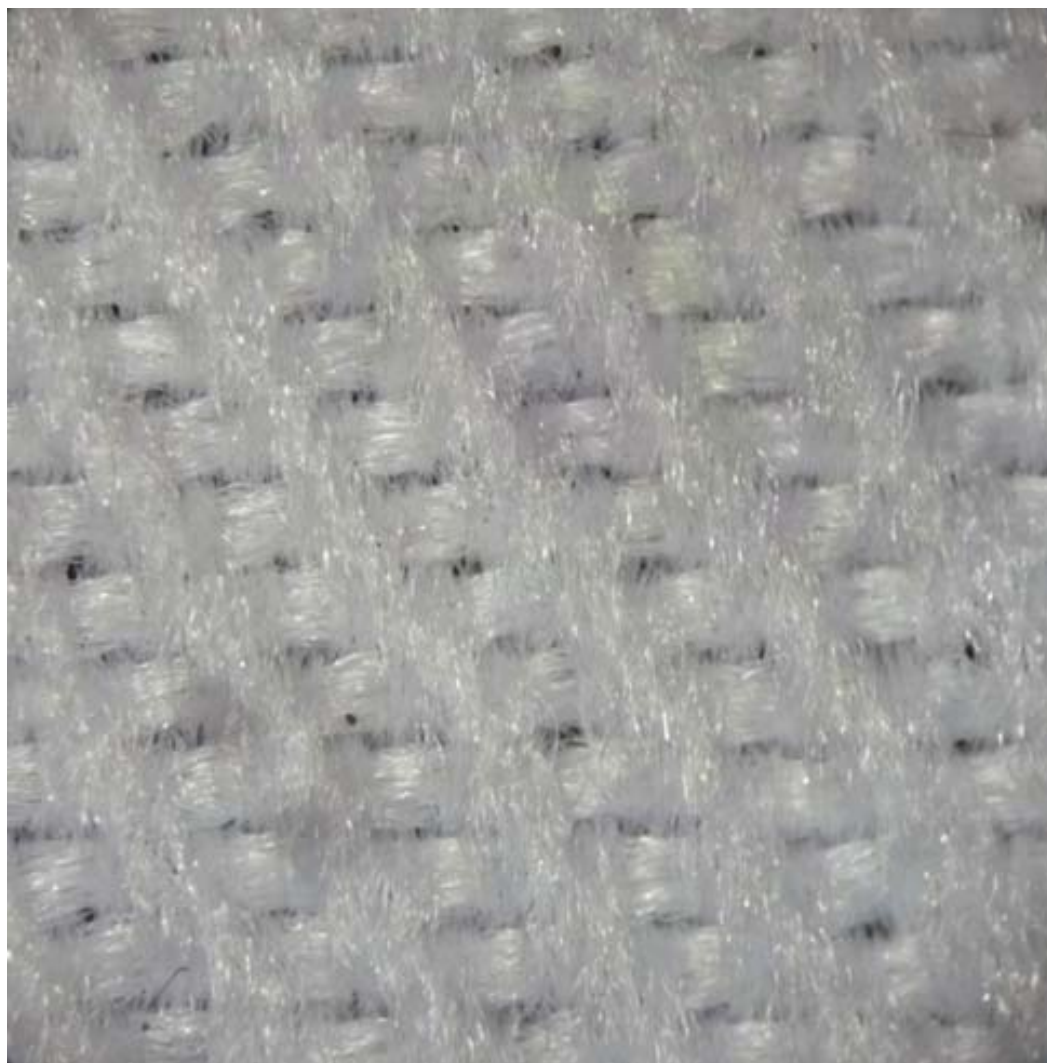
ภาพที่ ก.3 โครงสร้างผ้าทอแบบที่ 3 ลายทแยง (s-twill 1/3)
