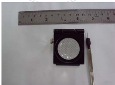
ภาพที่ 3.13 เครื่องมือทดสอบจำนวนเส้นด้ายต่อหน่วยความยาวผ้า
