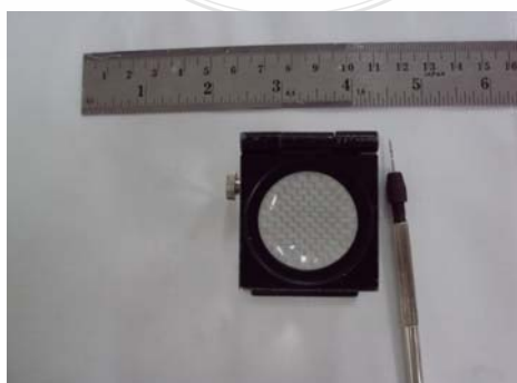
ภาพที่ 3.7 เครื่องมือทดสอบการนับจำนวนเส้นด้าย
