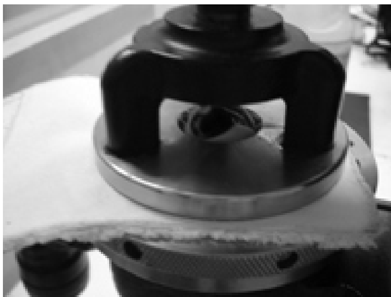
ภาพที่ ค.6 การทดสอบความแข็งแรงของผ้าต่อแรงดันทะลุ
