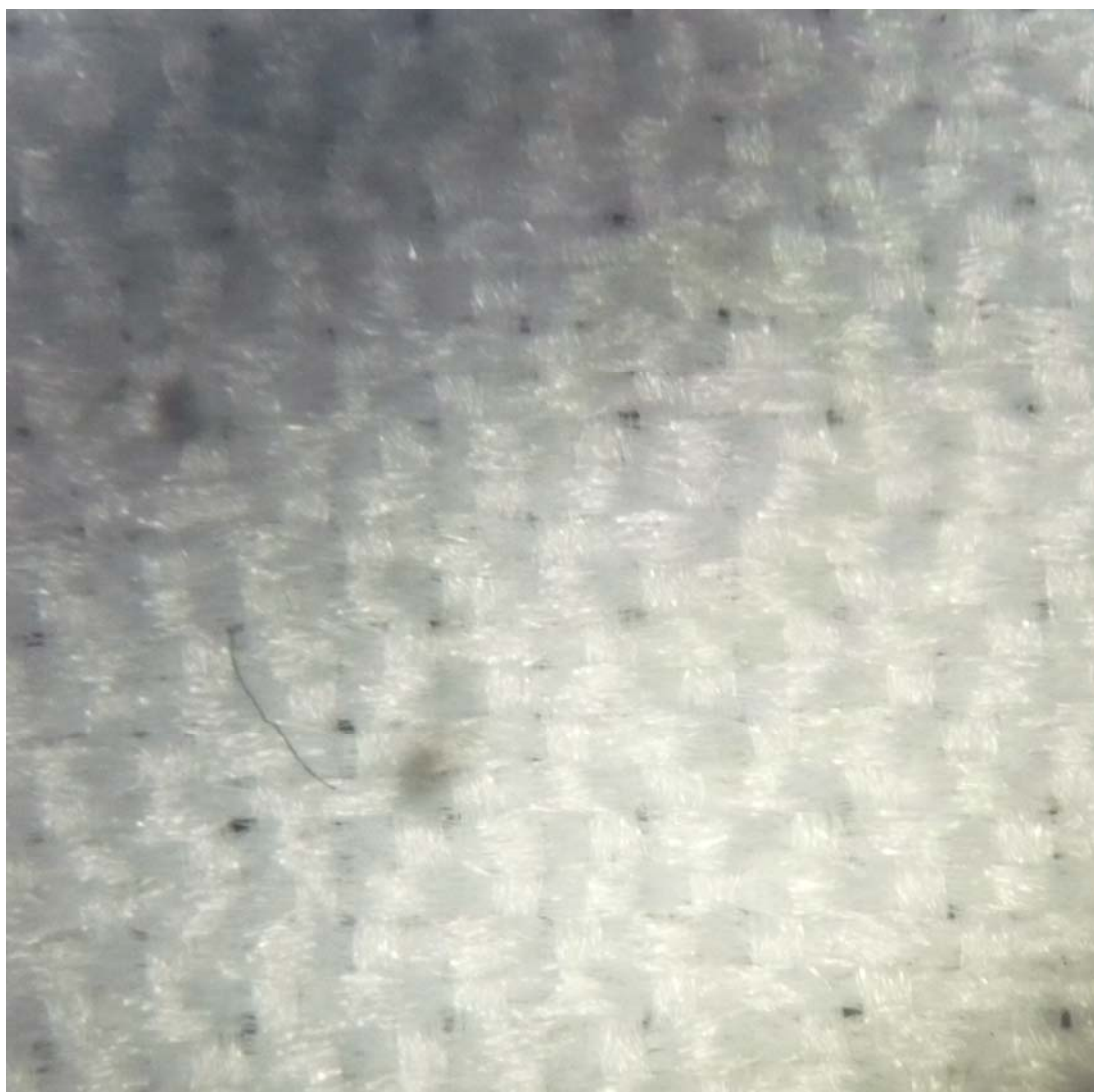
ภาพที่ ก.6 โครงสร้างผ้าทอแบบที่ 6 ลายทแยง (s-twill 1/3)
