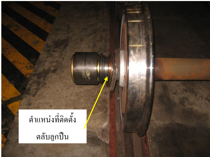
รูปที่ 3 แสดงลักษณะตัวเพลาล้อรถไฟ [2]
