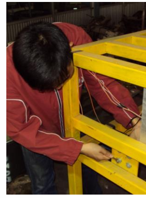
รูปที่ 53 แสดงการประกอบกระบอกนิวแมติกส์
