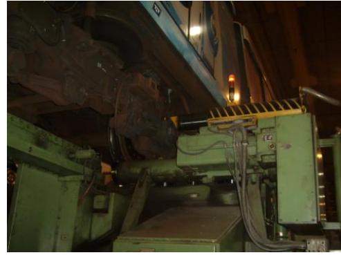
รูปที่ 26 ชุดต้นกำลังในการขับเคลื่อน
