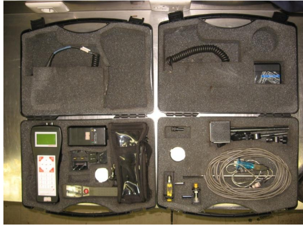
รูปที่ 28 เครื่องมือวัดและบันทึกผลการสั่นสะเทือน
