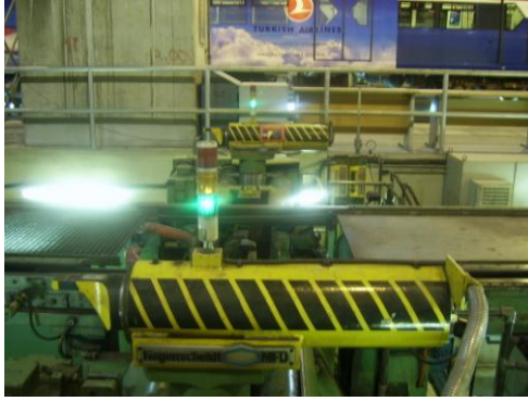
รูปที่ 25 เครื่องกลึงล้อ (Under Floor Wheel Lathe)
