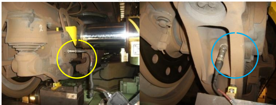
รูปที่ 31 การติดตั้งหัววัดในแนวแกนและแนวรัศมี (Axial, Radial)
