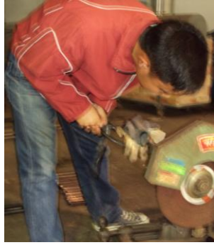
รูปที่ 50 แสดงการตัดเหล็กโครงสร้าง
