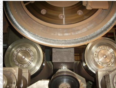
รูปที่ 27 ชุดอุปกรณ์ในการควบคุมเครื่องกลึงล้อ
