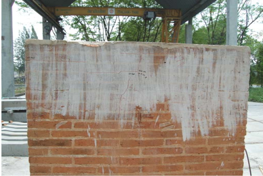
รูปที่ 4.15 ตัวอย่างการ crack ของผนังเสริม GFRP (3-stripe)
