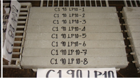
(ข) ชั้นตัวอย่างมอร์ตาร์ที่ใช้ทดสอบการหดตัวแห้ง
