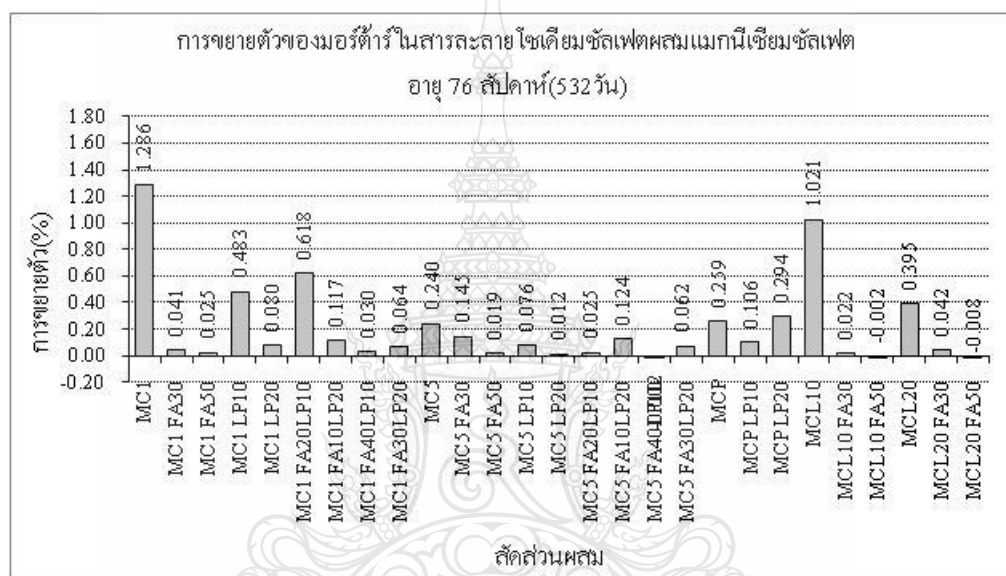
ภาพที่ 4.36 การขยายตัวของตัวอย่างมอร์ตาร์ปูนซีเมนต์ผสมเถ้าลอยและผงหินปูน ที่อายุ 76 สัปดาห์ ในสารละลายโซเดียมซัลเฟตผสมแมกนีเซียมซัลเฟต
