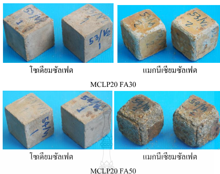
ภาพที่ 4.53 ภาพถ่ายเปรียบเทียบระหว่างสารละลายโชนีเยมซัลเฟตกับแมกนีเซียมซัลเฟตของตัวอย่างมอร์ตาร์ผสมเถ้าลอยและผงหินปูนที่อายุการแช่ในสารละลายซัลเฟต 900 วัน (ต่อ)
