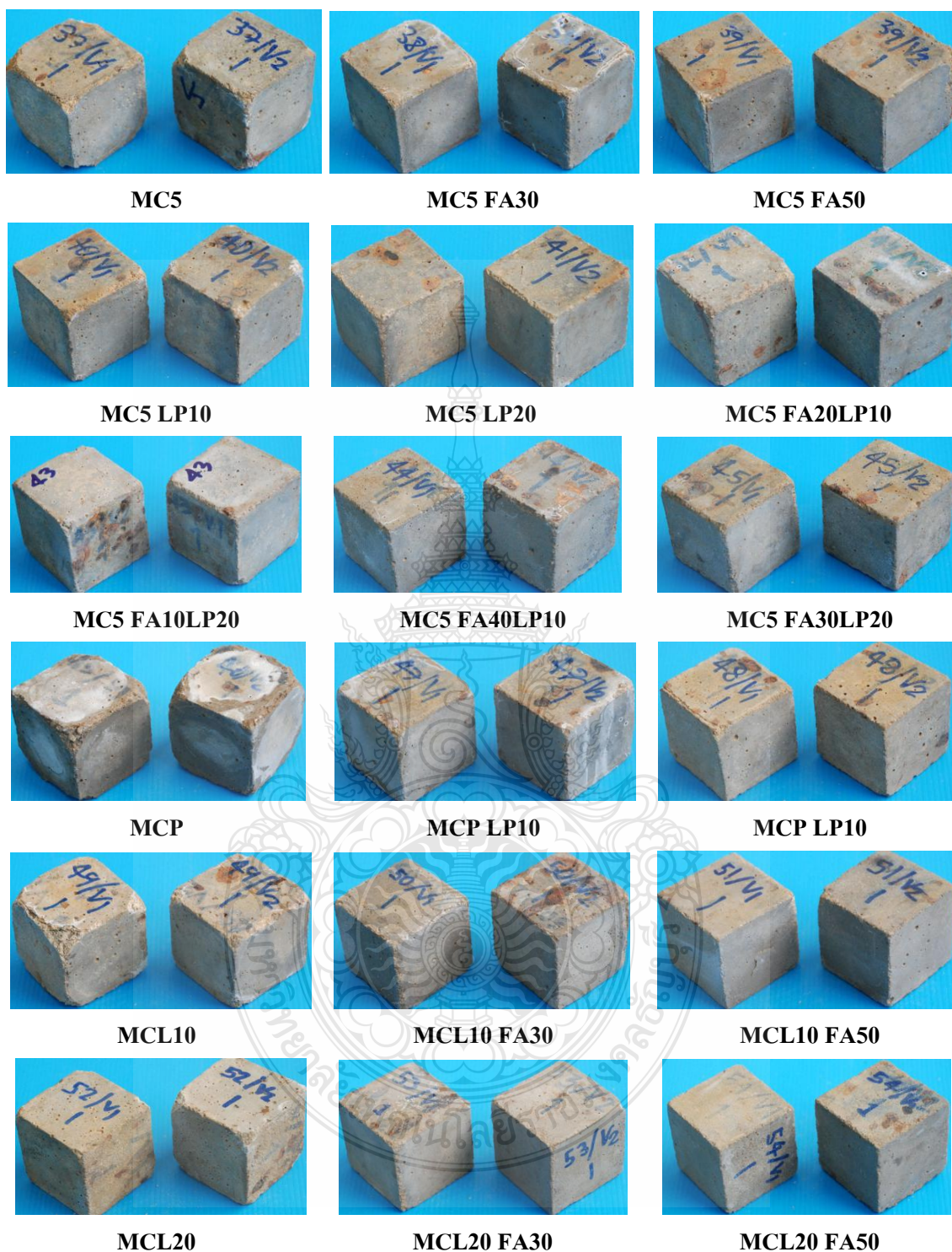
ภาพที่ 4.49 ภาพถ่ายตัวอย่างมอร์ต้าร์ที่แช่ในสารละลายโซเดียมซัลเฟต ที่อายุ 900 วัน (ต่อ)
