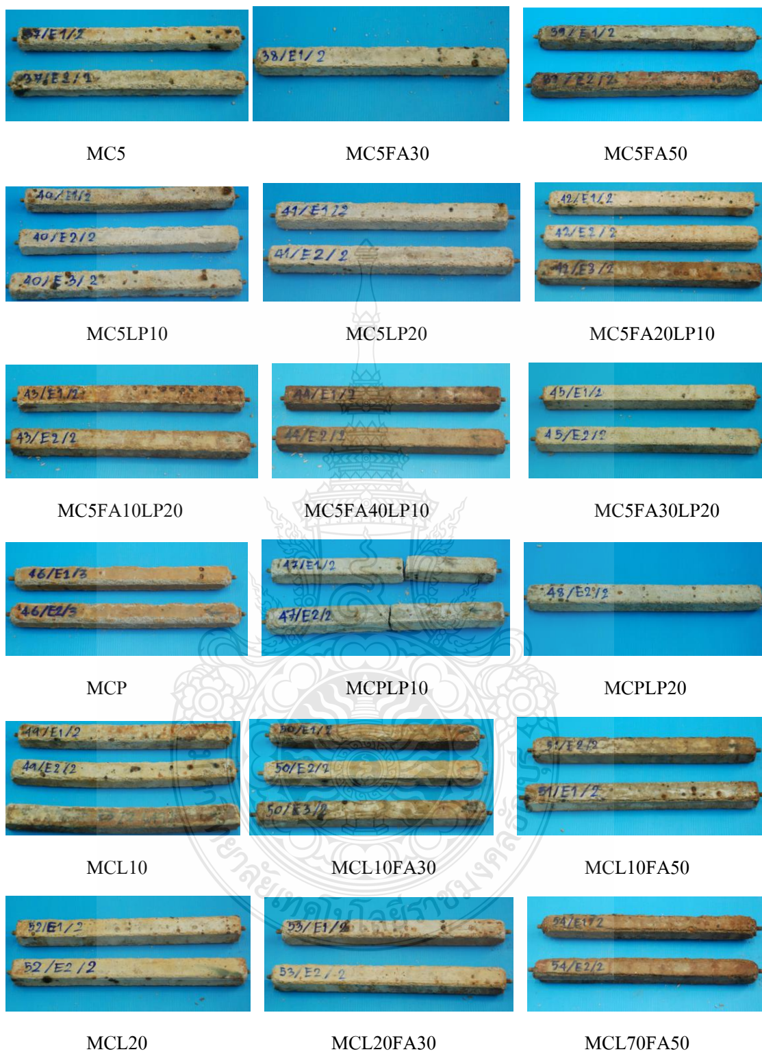
ภาพที่ 4.27 ภาพถ่ายของตัวอย่างมอร์ตาร์ปูนซีเมนต์ผสมเถ้าลอยและผงหินปูนที่อายุ 76 สัปดาห์ในสารละลายแมกนีเซียมซัลเฟต (ต่อ)
