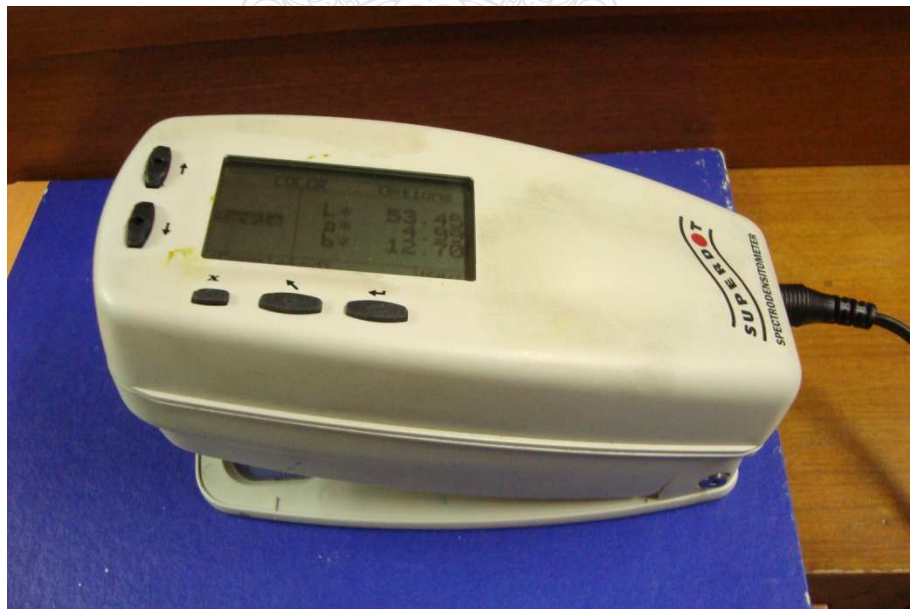
ภาพที่ 19 เครื่องวัดค่าสีบนสิ่งพิมพ์ และค่าความดำ (Spectro Densitometer)
