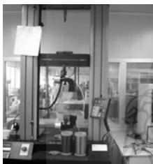
รูปที่ 17 เครื่องทดสอบความแข็งแรงต่อแรงดึง (tensile strength tester) ยี่ห้อ Instron รุ่น 5569
