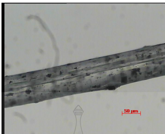
ภาพที่ 4.15 โพลีโพรพิลีนผสมผงถ่านจากขี้ข้าวโพดร้อยละ 1
