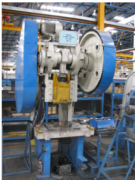
ภาพที่ 3.26 ลักษณะของเครื่องเพรสแบบเพลาค้อเหวี่ยงขนาด 40 ตัน
