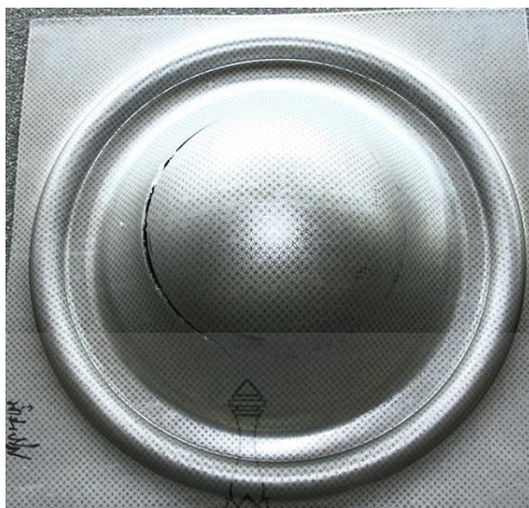
ภาพที่ ค.4 ชิ้นรูปขึ้นทศสอบจากแผ่นเต็ม สารหล่อลื่นน้ำมันรีโนฟอร์ม
