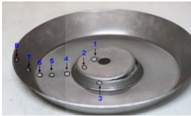
รูปที่ 1 ตำแหน่งการวัดการยืดตัวของกริดวงกลม
