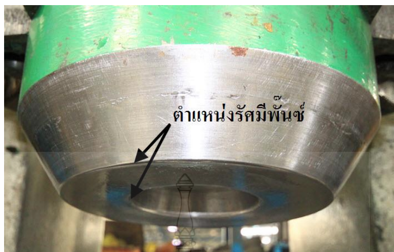
ภาพที่ 3.28 ลักษณะแม่พิมพ์พื้นซ์
