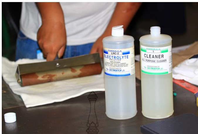
ภาพที่ ค.2 สร้างกริดโดยวิธีกัดกรดด้วยไฟฟ้า (Electrochemical Etching)
