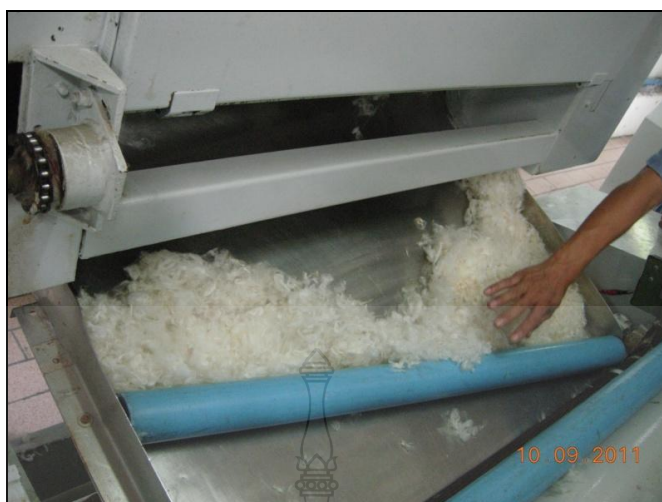
ภาพที่ 3.21 การป้อนเส้นใยผ่านเครื่องสาวใย
