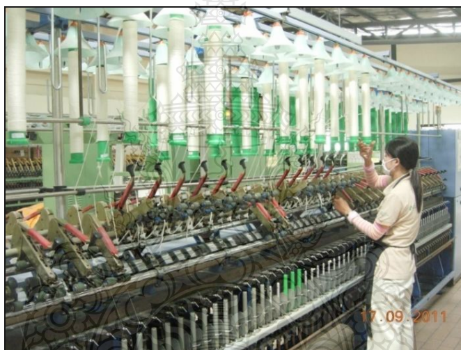
ภาพที่ 3.33 การป้อนเส้นโรฟวิ่งเข้าเครื่องปั่นด้ายแบบวงแหวน
