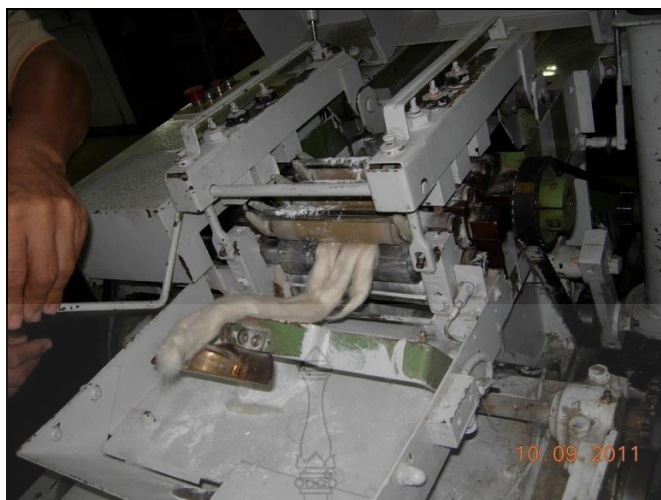
ภาพที่ 3.28 การลดขนาดของเส้นสไลเวอร์เขาคอน
