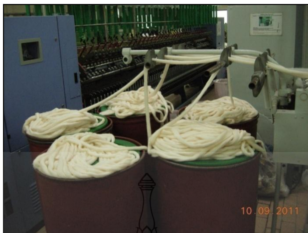
ภาพที่ 3.26 การนำเส้นสไลเวอร์เขาคอนผสมเข้าเครื่องรีดปุย จำนวน 5 เส้น
