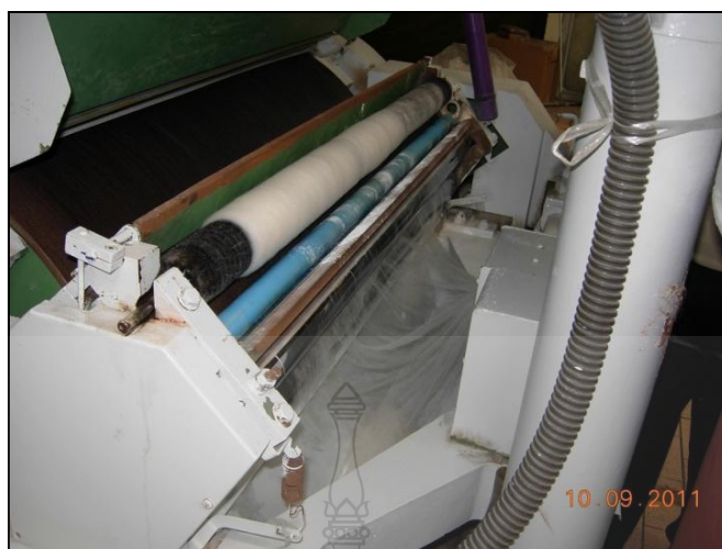
ภาพที่ 3.23 เส้นใยเขาคอนผสมที่ผ่านลูกกลิ้งหนามภายในเครื่องสาวใย
