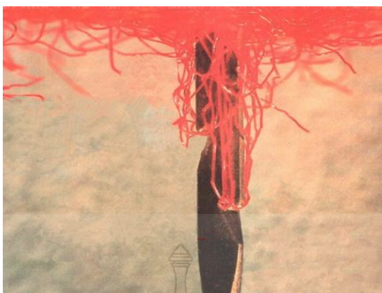
ภาพที่ 2.28 ลักษณะเข็มเจาะที่ผ่านเส้นใย [15]
