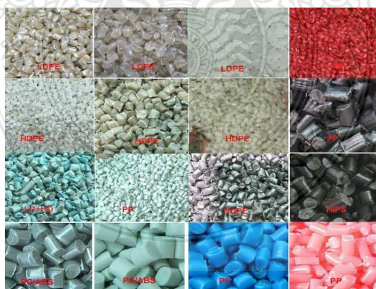
ภาพที่ 2.8 เม็ดพลาสติกที่ใช้ในการผลิตผ้าไม่ทอ [4]
