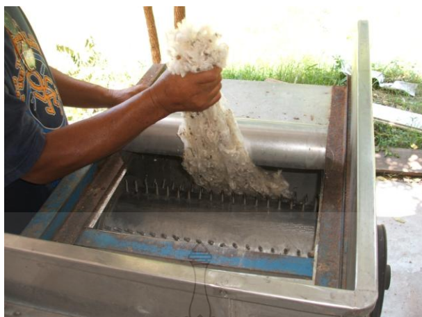
ภาพที่ ก.10 วิธีการป้อนเศษรังไหมเข้าเครื่อง
