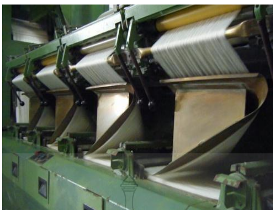
ภาพที่ 2.13 การเรียงซ้อนแผ่นเส้นใยในทิศทางเดียวกัน
