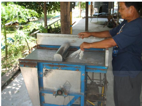
ภาพที่ ก.7 วิธีการป้อนเศษรังไหมเข้าเครื่อง
