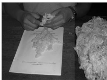
รูปที่ 5 การตัดให้เส้นใยสั้นประมาณ 2 - 4 เซนติเมตร
