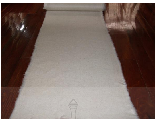
ภาพที่ 3.11 ผ้านอนวูฟเวนที่ทำจากเศษรังไหม
