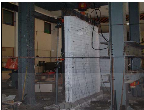
ภาพที่ 2.21 การทดสอบผนังคอนกรีตบล็อกประสาน [9]
