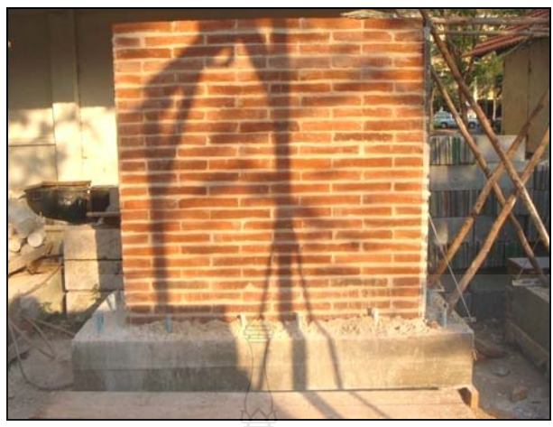
ภาพที่ 3.8 ผนังเป็นตัวอย่างที่ใช้ในการทดสอบ
