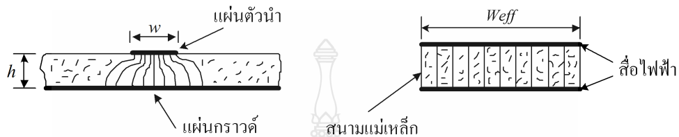
ภาพที่ 2.5 การส่งผ่านของคลื่น TEM แบบอุดมคติในไมโครสตริป [30]
