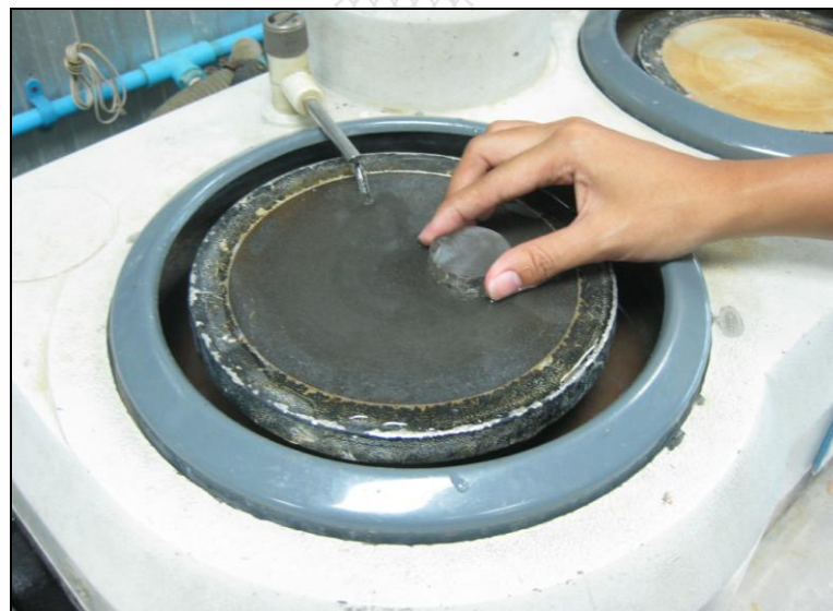
รูปที่ 9 ข. เครื่องขัดผิวชิ้นงานทดสอบที่ภาควิชาวิศวกรรมอุตสาหกรรม มหาวิทยาลัยเทคโนโลยีราชมงคลธัญบุรี
