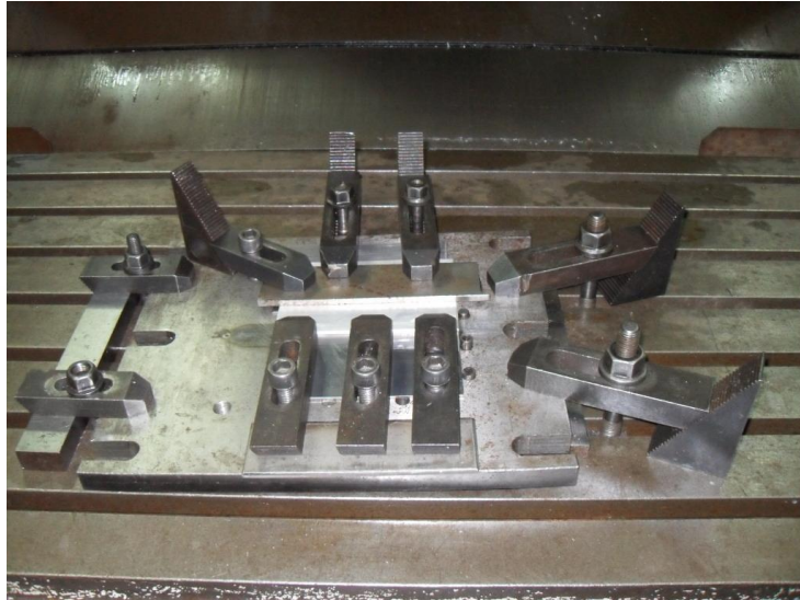
รูปที่ 3.7 การจับยึดชิ้นงานก่อนการเชื่อม
