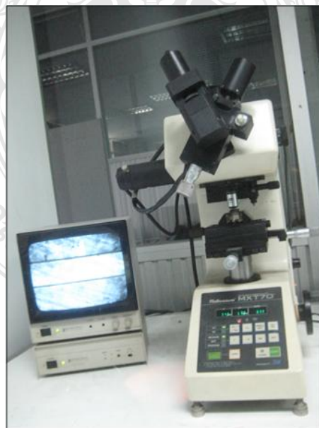
รูปที่ 3.24 เครื่องทดสอบความแข็งแบบวิกเกอร์
