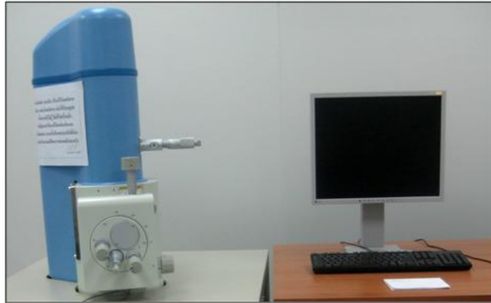
รูปที่ 3.22 กล้องจุลทรรศน์อิเล็กตรอนแบบส่องกราด
