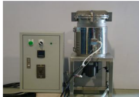
รูปที่ 1 ชุดถังปฏิกรณ์ขนาดประมาณ 4 ลิตร
