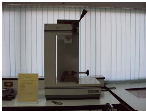
รูปที่ 3.44 เครื่องทดสอบการทนต่อแรงกระแทก
