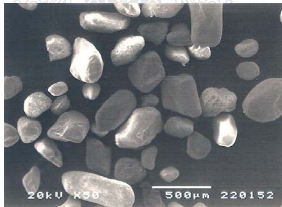
รูปที่ 4.9 ภาพถ่าย SEM ของแร่ลู่โคชิน ที่กำลังขยาย 50 เท่า
