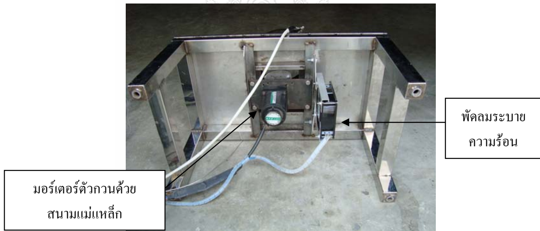
รูปที่ 3.6 การติดตั้งตัวกวนด้วยสนามแม่เหล็ก
