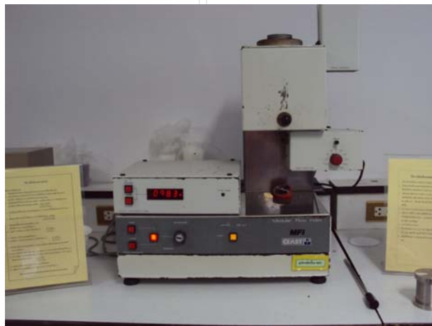
รูปที่ 3.41 เครื่องทดสอบค่าดัชนีการไหล (Melt Flow Index ,MFI)
