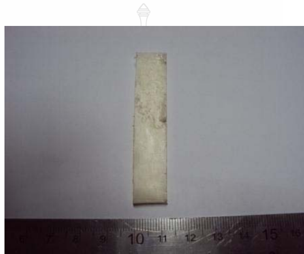
รูปที่ 3.42 ซีนทดสอบการทนต่อแรงกระแทกตามมาตรฐาน ASTM D 256
