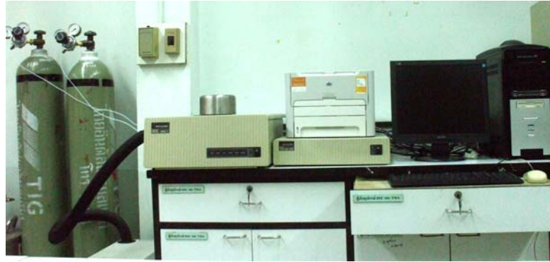
รูปที่ 3.37 เครื่องตรวจวัดความแตกต่างของพลังงาน Perkins-Elmer DSC TAC 7
