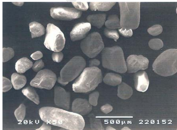
รูปที่ 4.15 ภาพถ่าย SEM ของแร่ลูโคซีนที่กำลังขยาย 50 เท่า
