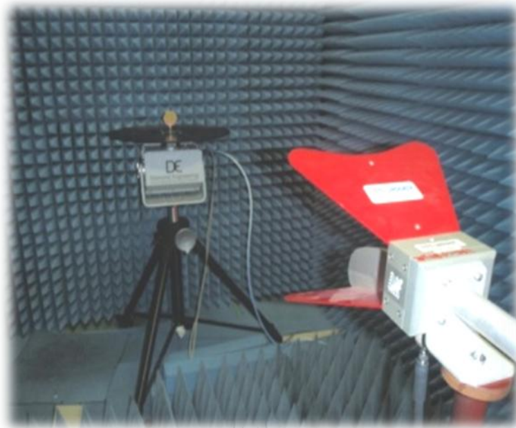
รูปที่ 4.6 แสดงอุปกรณ์ต่างๆและการต่อเพื่อทดสอบกับเครื่องวิเคราะห์ข่ายงานไฟฟ้า
