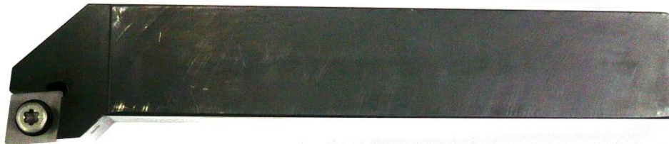
รูปที่ 3.4 ค้ำจับเม็ดมีดกลึงที่ใช้จับเม็ดมีดทั้ง 3 ชนิด
