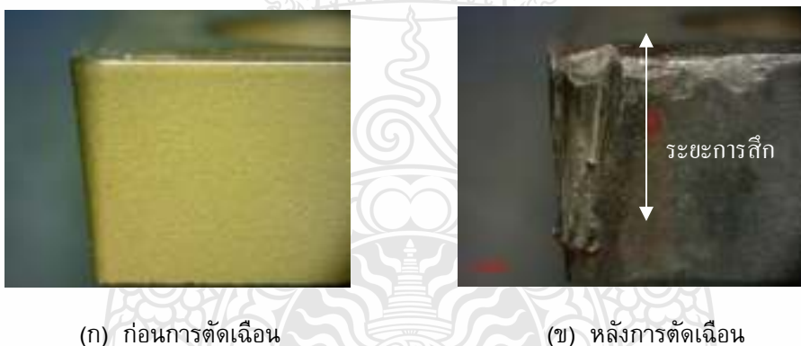
รูปที่ 6 ภาพถ่ายการสึกหรอของเม็ดมีดชนิด KC ก่อนและหลังทำการตัดเฉือนชิ้นส่วน
