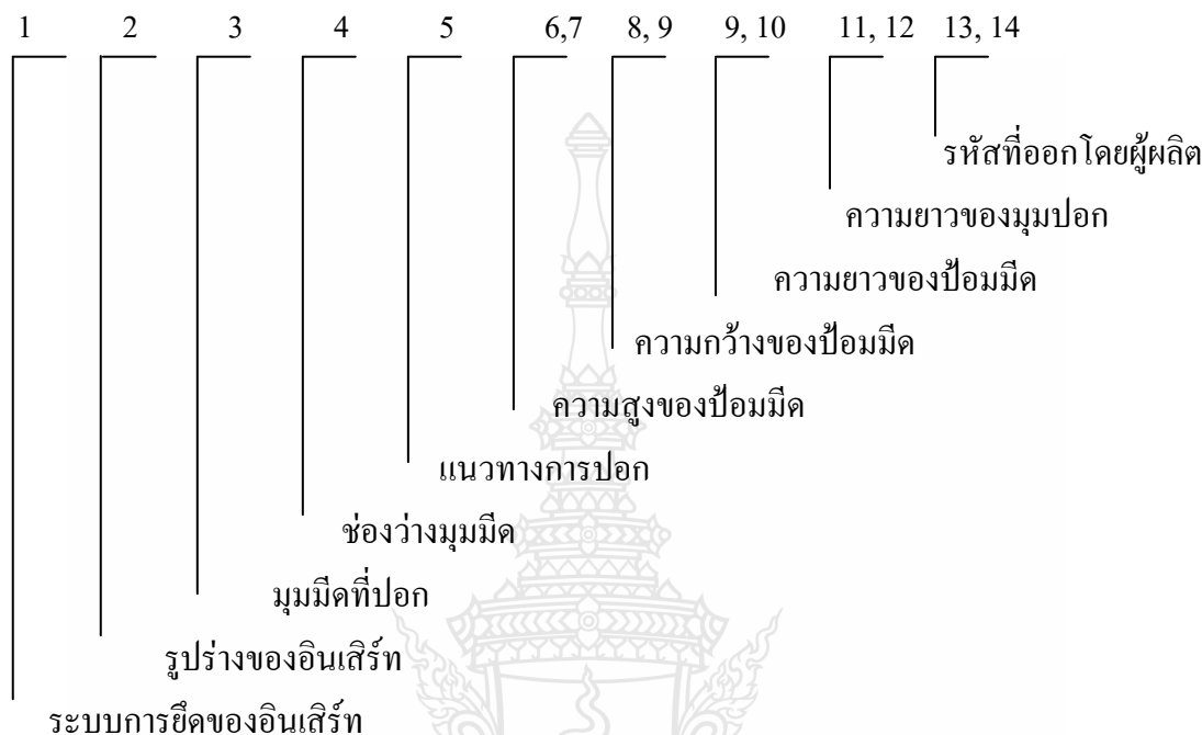
รูปที่ 2.3 ตำแหน่งเลขรหัสการเลือกใช้เม็ดคอลลิ่งตามมาตรฐาน ISO
