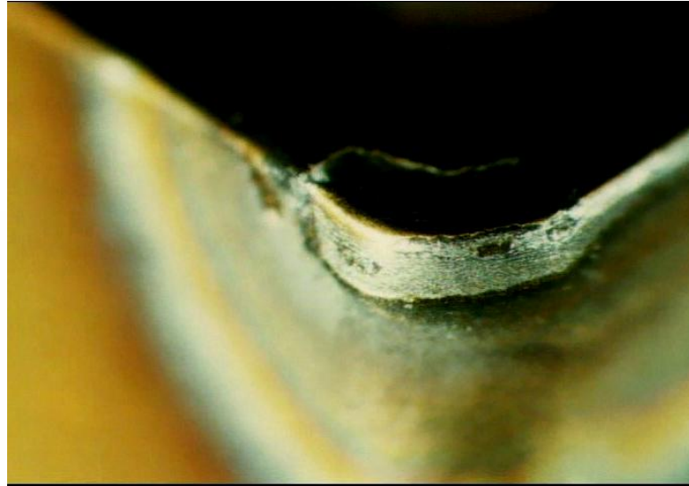
รูปที่ 2.6 การสึกหรอที่ปลายมีด (Nose Wear) [5]
