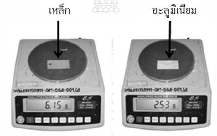
รูปที่ 3.6 ชั่งน้ำหนักชิ้นงานก่อนทำการทดสอบ
