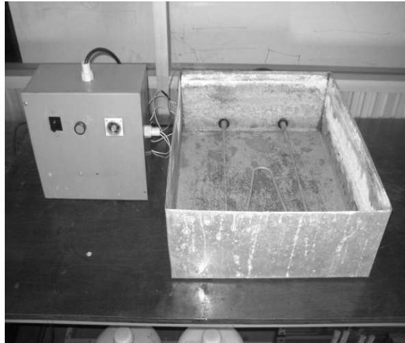
รูปที่ 3.13 ชุดควบคุมอุณหภูมิในการทดสอบการกัดกร่อน
