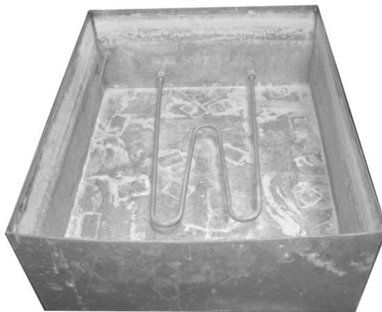
รูปที่ 3.12 อ่างให้ความร้อนที่ทำการติดขดลวด (Heater) แล้ว
