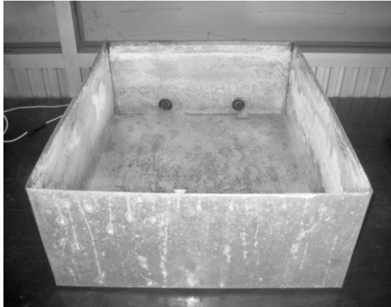
รูปที่ 3.11 อ่างให้ความร้อนที่เจาะรูเรียบร้อยแล้ว
