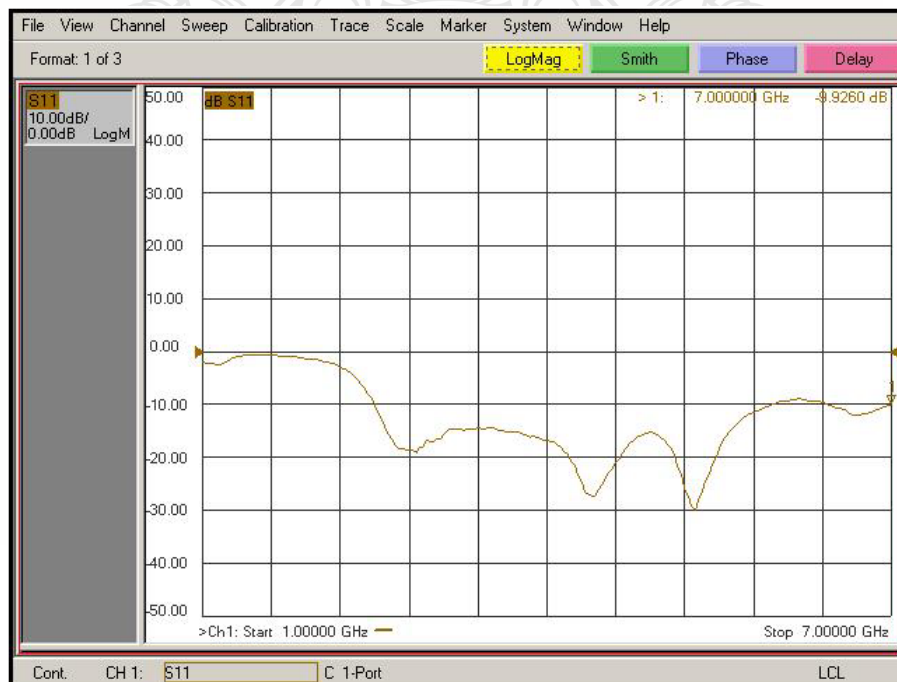
รูปที่ 4.1 ผลการวัดการสูญเสียย้อนกลับแสดงบนหน้าจอเครื่องวิเคราะห์โครงข่าย
