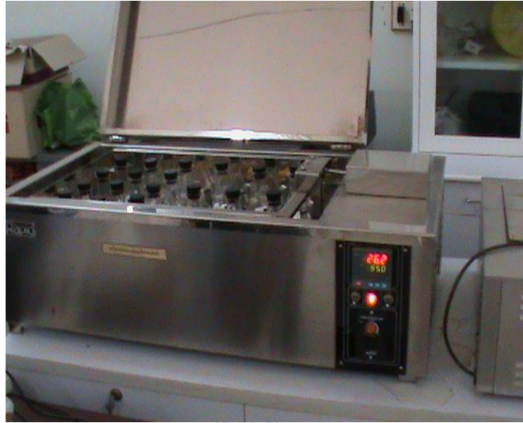
รูปที่ 3.9 อ่างน้ำร้อนแบบเขย่า
