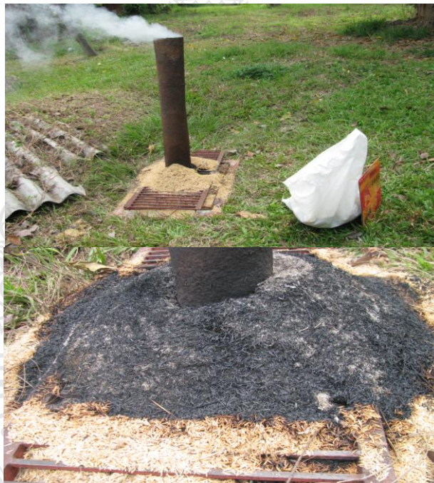
รูปที่ 3.1 วิธีการเผาแกลบโดยใช้ท่ออากาศช่วย
