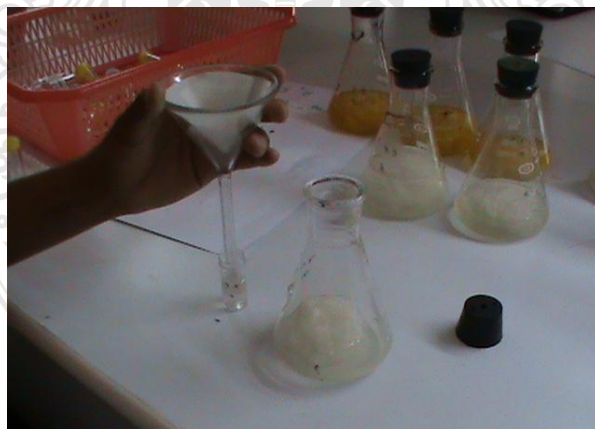
รูปที่ 3.13 กรองตัวอย่างด้วยกระดาษกรองเบอร์ 1
