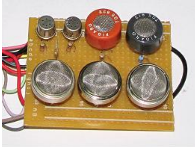
รูปที่ 3.9 เซ็นเซอร์รับกลิ่นที่ทำจากแก๊สเซ็นเซอร์ใช้ดมกลิ่นเสื้อบุคคล
