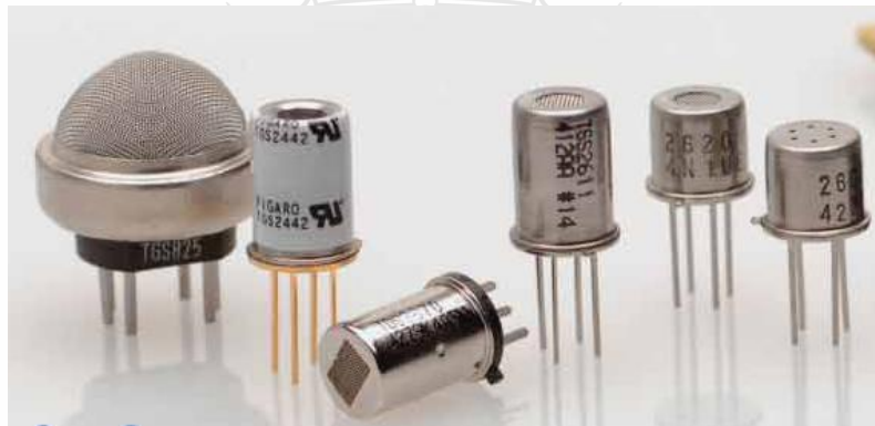
รูปที่ 2.13 เซ็นเซอร์แบบ Metal Oxide Semiconductor รุ่นต่างๆ [6]
