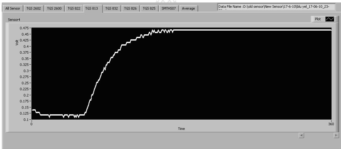
รูปที่ 3.19 สัญญาณเอาต์พุตของแก๊สเซ็นเซอร์รุ่น TGS 813 เมื่อทดสอบดมกลิ่นเสื้อตัวอย่าง
