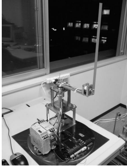
รูปที่ 2.4 ระบบอินเวอร์ทเพนดูลัมแบบฐานหมุน [7]
