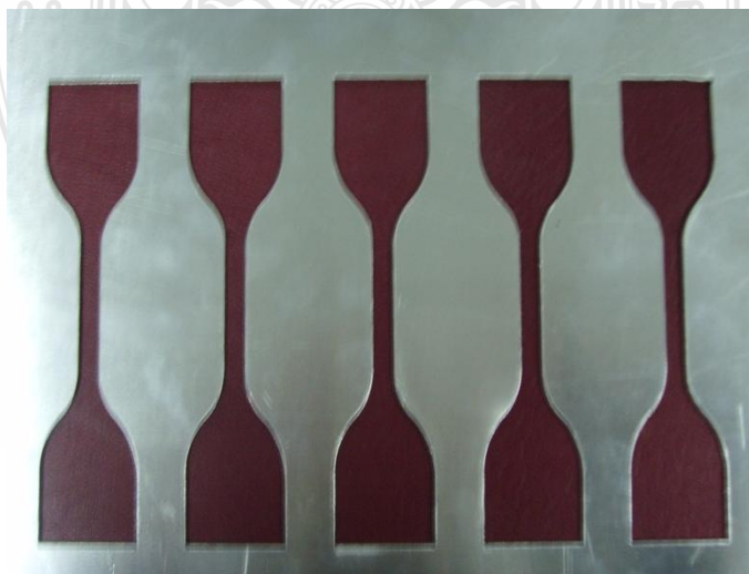
รูปที่ 3.20 แม่พิมพ์ขึ้นรูปชิ้นงานทดสอบแรงดึงตามมาตรฐาน ASTM D 638 Type IV
