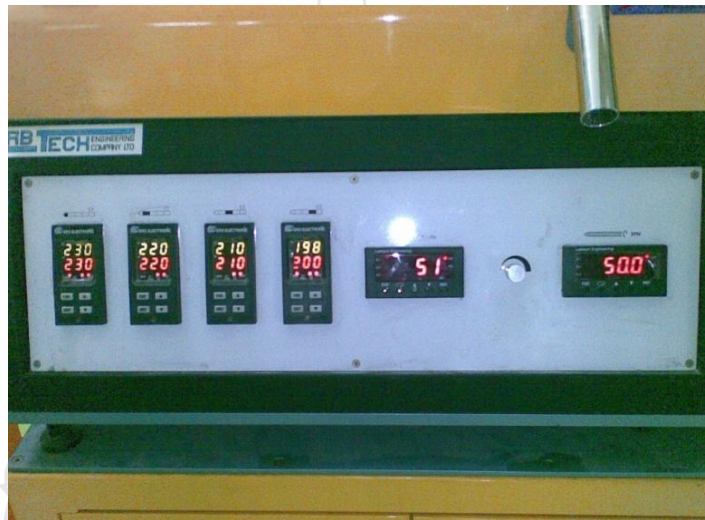
รูปที่ ก.3 อุณหภูมิและความเร็วรอบที่ใช้ในการผสม
