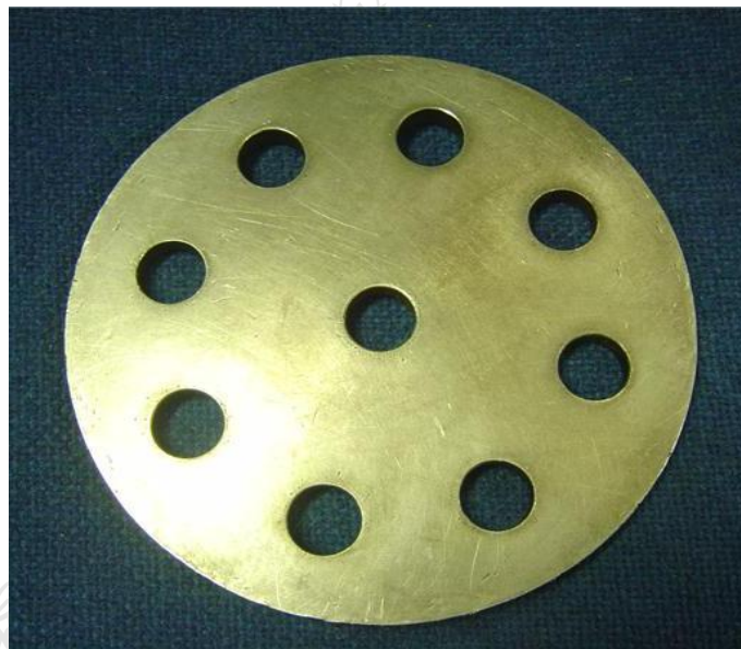
รูปที่ 3.24 แม่พิมพ์ขึ้นรูปชิ้นงานทดสอบความเสียดทานตามมาตรฐาน DIN 53516
