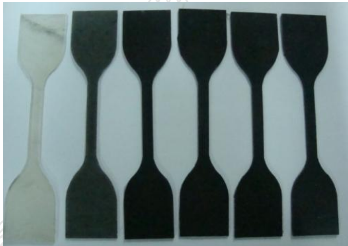
รูปที่ 3.22 ชิ้นงานทดสอบแรงดึงตามมาตรฐาน ASTM D 638 Type IV
