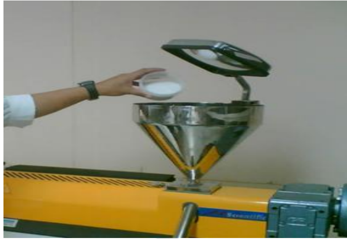
รูปที่ ก.2 การใส่วัสดุลงในเครื่องเครื่องอัดรีดแบบเกลียวหนอนเดี่ยว
