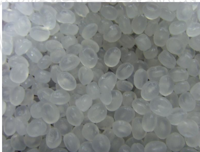
รูปที่ 3.2 เม็ดพลาสติกพอลิพรอพิลีน PP เกรด H255JA
