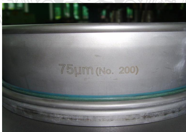
รูปที่ 3.7 ตะแกรงร่อนมาตรฐาน ขนาด 200 เมช
