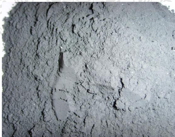
รูปที่ 4.1 ซีตกรันอะลูมิเนียมขนาด 75\mu m ที่ได้จากการบดและคัดขนาด
