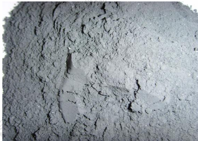
รูปที่ 3.9 จี้ตระกรันอะลูมิเนียมที่ได้จากการบดและคัดขนาด
