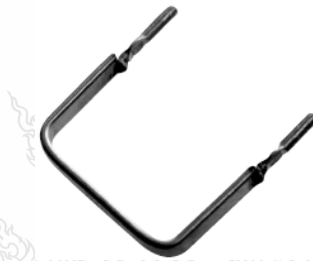
รูปที่ 2.4 ความต้านทานที่ใช้ในการตรวจสอบกระแส [23]
