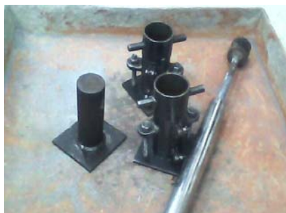
รูปที่ 2 Minicompactor สำหรับการเตรียมตัวอย่างดิน
